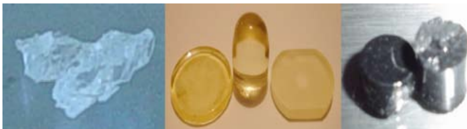
Figura 3. a) Polímero de ASEA obtenido por polimerización térmica de radicales libres, b) Polímero de ASEA obtenido por radiación gamma, c) Compósito polimérico de ASEA con NC (10% en peso) obtenido por radiación gamma.
