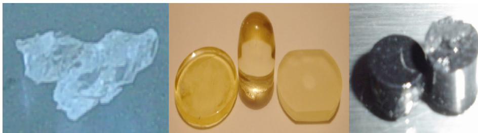
Figura 1. a) Polímero de ASEA obtenido por polimerización térmica de radicales libres, b) Polímero de ASEA obtenido por radiación gamma, c) Compósito polimérico de ASEA con NC (10% en peso) obtenido por radiación gamma.
