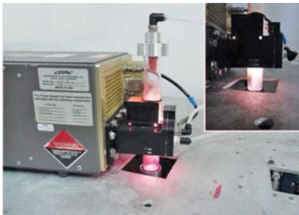
Figura 22. Reactor LF-PIM implementado en CNYN-UNAM. El plasma es confinado a la cavidad del microondas (adaptación de Soto et al. , 2011). Véase Figura 12 en página VI del anexo de color.
