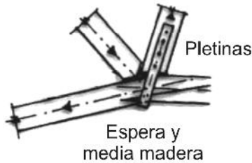
Fig. 9.72. Unión de Tirante-Tirantilla-Tornapunta.
