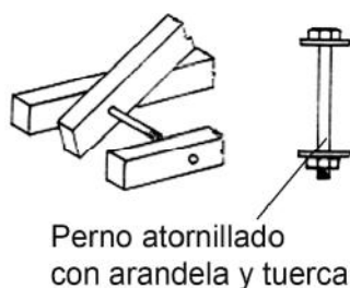
Fig. 8.32. Uniones con perno.
