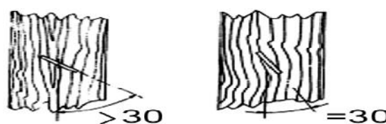
Fig. 8.45. Ángulos entre la corona de la grapa y las fibras de la madera.
