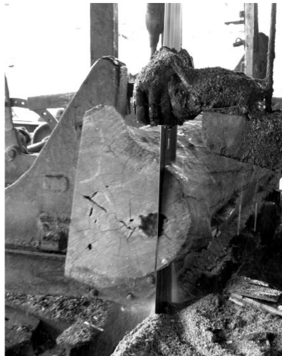
Fig. 4.3. Troceado de un tronco mediante el método de cortes tangenciales y paralelos.
