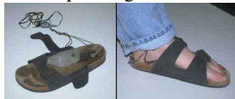
Figura 7.3: Zapato con sensor de respuesta galvánica de la piel(MIT Media Lab, 2014)
