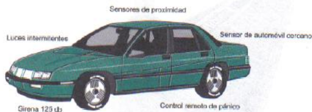
Figura 3.1. Automóvil con sistema de alarma.
