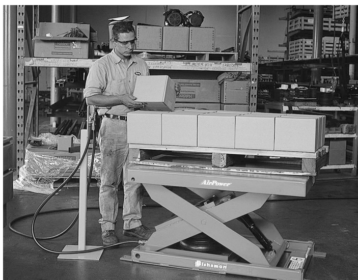
Figura 3.16 Mesa elevadora hidráulica que se utiliza para minimizar la elevación manual. (Cortesía de Bishamon.)
