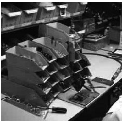
Figura 4.12 Estación de trabajo ideal que permite al operario ensamblar un producto a través de una serie de movimientos simétricos realizados de manera simultánea hacia afuera y hacia el centro del cuerpo.
