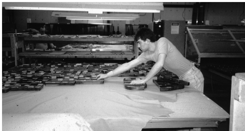
Figura 3.6 Distribución de los troqueles de corte sobre una base bronceada antes de ingresar a la prensa rotatoria (observe la cuidadosa distribución de los troqueles con el fin de maximizar el uso de la costosa piel).
