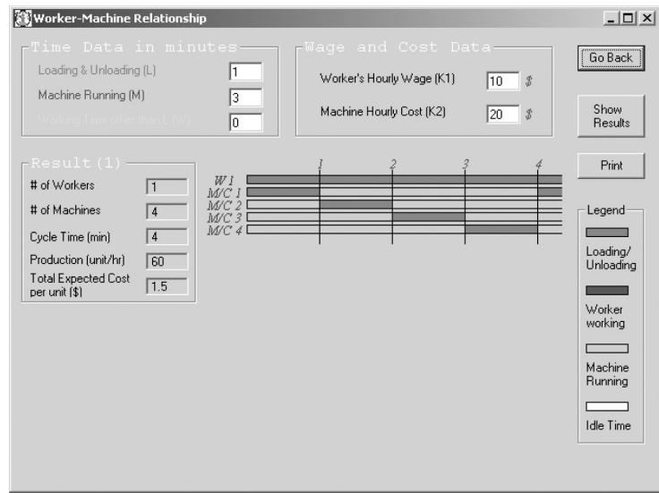
Figura 2.17 Asignación de servicio sincrónico para un operador y cuatro máquinas.
