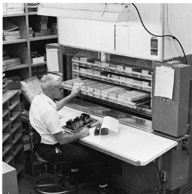
Figura 3.15 Área de trabajo de máquinas de almacenamiento vertical que se utilizan en el ensamblado de tableros de computadoras.
