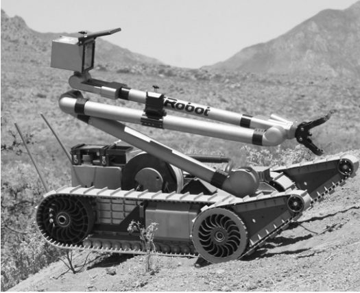
FIGURA 14-2 El PackBot listo para emplearse en una operación militar de búsqueda.
