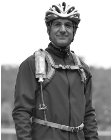
FIGURA 3-7 Sistema de aportación de nutrientes en prueba de uso a cargo de su inventor, Matt Kressy (bolsa de nutrientes, tubos y válvula en su hombro derecho).
