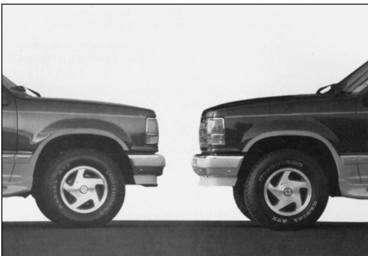
FIGURA 13-11 Ejemplo de estandarización dentro de un modelo. Las ruedas del Ford Explorer son iguales en los lados derecho e izquierdo.
