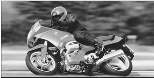
FIGURA 10-5 Motocicleta BMW R1100RS. Este producto muestra una funcionalidad compartida y una arquitectura integral con el diseño del trozo de la transmisión.
