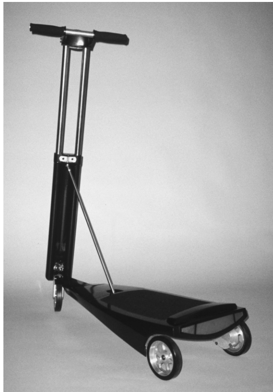
FIGURA 9-1 Prototipo del concepto de producto del patín eléctrico de emPower Corporation.
