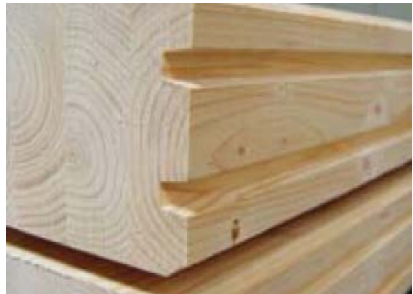
Figura 69. Preparación de los Glulam para el ensamblaje.
