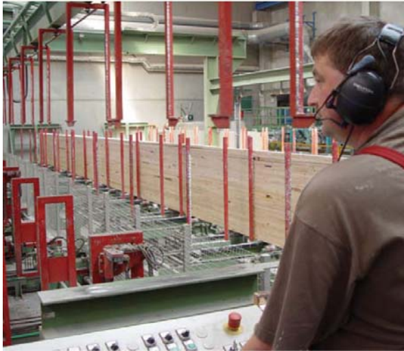
Figura 68. Línea de producción de Glulam.
