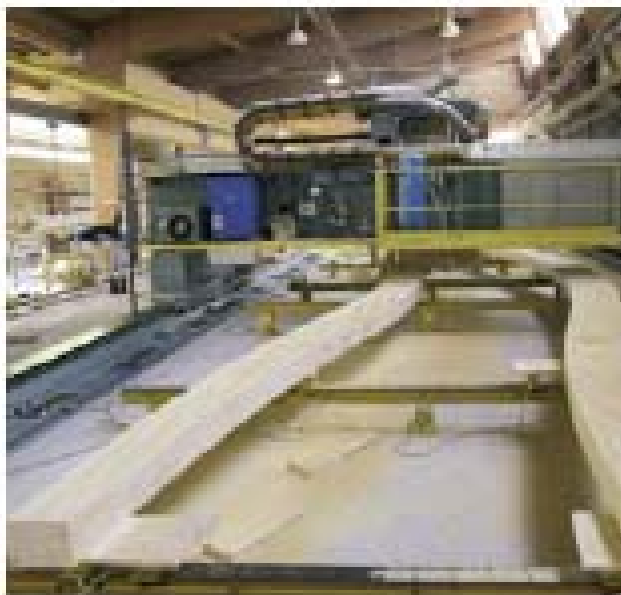
Figura 75. Estación de corte programado por computador.
