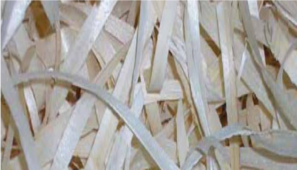
Figura 34. Preparación de madera para WWCB.
