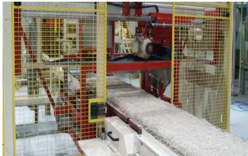
Figura 37. Estación de formación para WWCB.
