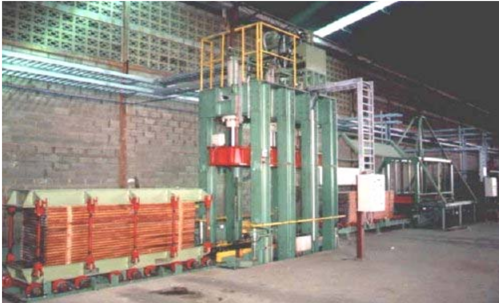
Figura 33. Línea de prensado tecnología holandesa de WWCB (25) .
