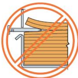
Perforación en ángulo incorrecto
