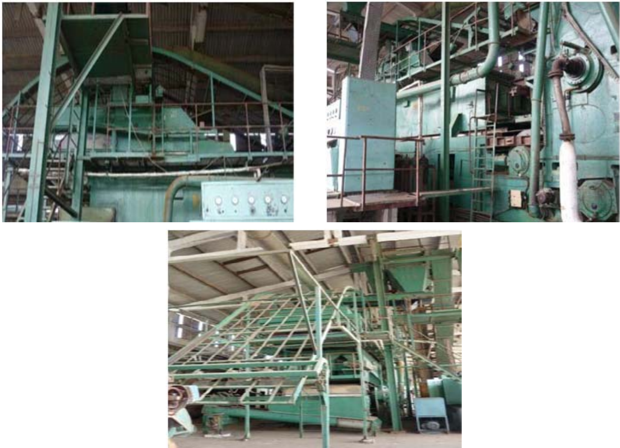
Figura 19. Línea de formación y prensado tecnología Mende.
