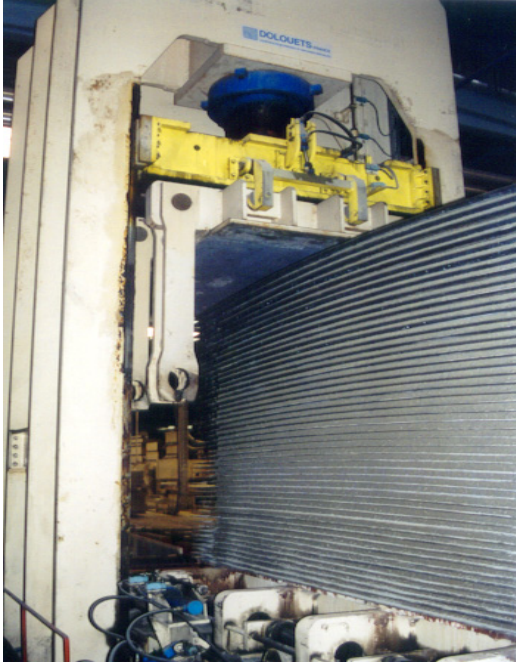
Figura 31. Prensa para la tecnología de tableros de partículas de madera aglomeradas con cemento.
