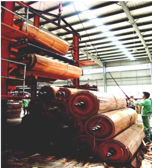
Figura 1. Preparación de láminas de madera para la producción de plywood .
