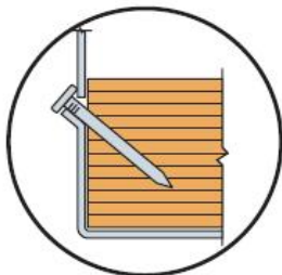
Perforación correcta En ángulo aproximado de 45°
