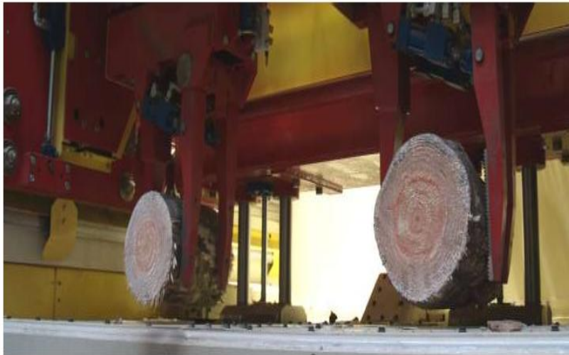
Figura 36. Rolos para cortadoras radiales empleadas en los WWCB.
