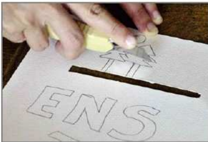
Forma correcta de ubicar las manos para evitar cortarse al calar.
