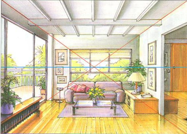
Fig. 315. Y ya podemos situar muebles, lámparas, cortinas, etc. siempre teniendo en cuenta las fugas y si es necesario dibujando en planta el plano de la habitación.
