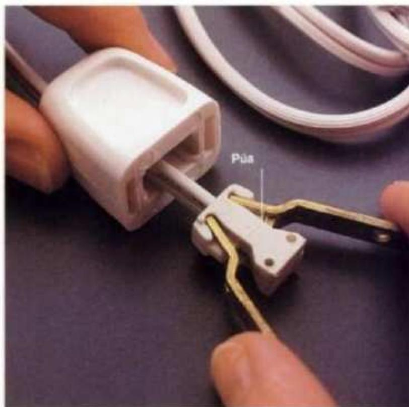
**2** Empuje el cordón plano por atrás de la caja de la clavija. Abra las puntas e inserte el alambre hacia adentro de la abertura en la parte de atrás del núcleo. Apriete las dos puntas, las dos puás de las puntas dentro del núcleo penetran en el cordón para hacer contacto con los alambres de cobre. La caja se desliza por arriba del núcleo de la clavija hasta que el núcleo se asienta en su lugar.
