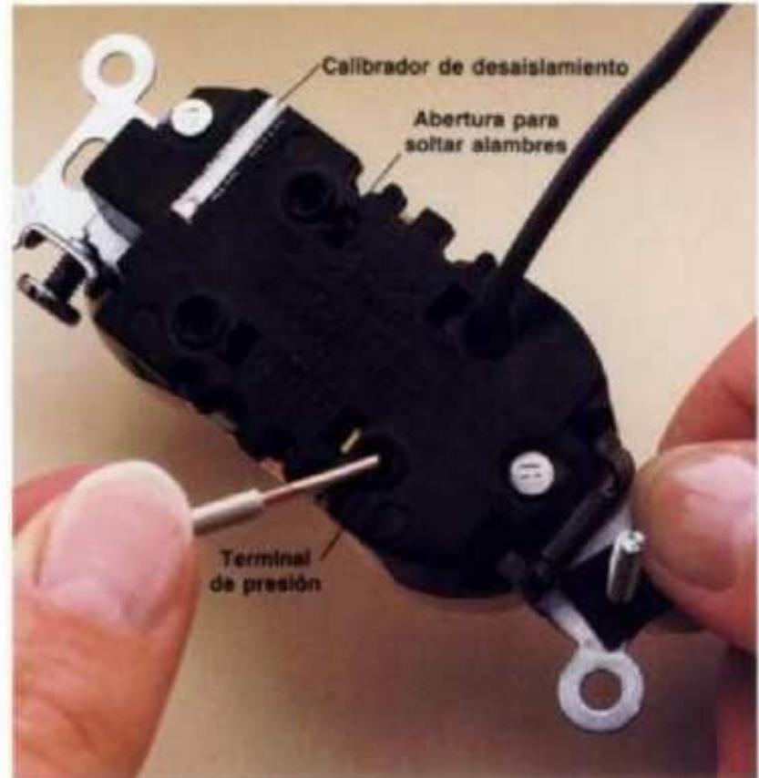
**Se hacen conexiones rápidas** en cajas de salida y en interruptores si se sigue el método de quitar la longitud de forro marcada por el calibrador de desaislamiento. Insertar los alambres desnudos en las terminales de presión. En los enchufes el cable negro se coloca adentro del agujero próximo al tornillo más oscuro. Para soltar la conexión se empuja con un clavo o la punta de un desarmador pequeño en la abertura cercana al alambre.
