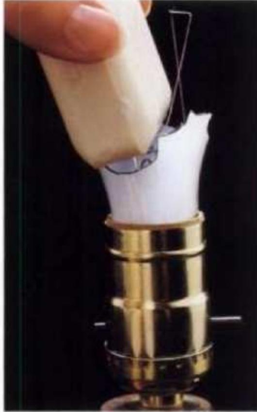
Para quitar un foco de luz quebrado, se desconecta primero la electricidad o se desenchufa la lámpara; después se inserta una pastilla de jabón, que se gira en sentido contrario a manecillas de reloj. Desechar el jabón. O bien, puede usar pinzas de punta para sujetar el filamento o la base metálica del foco.
