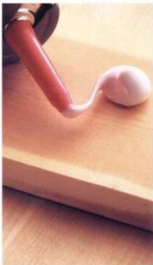
**4** Apoye el tubo de calafateo sobre madera de desecho y jale hacia atrás el émbolo para evitar que gotee. Elimine de la punta el sobrante. Tape la punta para evitar que el tubo se seque.
