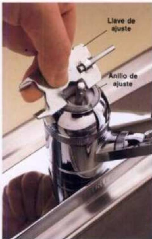
**2** Apretar el anillo de ajuste con la llave que viene con el juego de repuestos (en algunos modelos, usar las pinzas ajustables para apretar la tapa). Montar de nuevo la manija y abrir la válvula del agua. Si el grifo todavía gotea, cerrar de nuevo la válvula del agua y quitar la manija.
