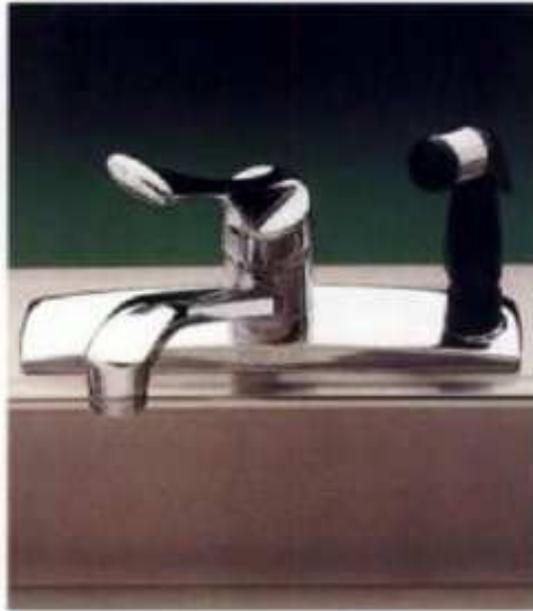
**Los grifos de bola** tienen un collarín redondo en la manija de una sola palanca. Debajo del collarín se encuentra una tapa cóncava. Por lo general, la manija está montada al grifo por medio de un tornillo opresor localizado en el collarín. En el interior, una bola plástica o metálica controla el volumen y la temperatura del agua.
