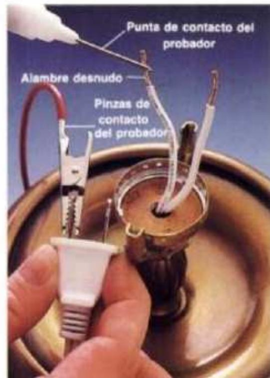
**4** Con el probador de continuidad detecte las averías en el cordón de la lámpara. Ponga las pinzas de contacto del probador en una de las puntas de la clavija. Tocar con la punta de probar a una terminal desaislada; después, la otra. Se repite la prueba con la otra punta de la clavija. Si el probador no se enciende, se debe cambiar el cordón y la clavija. Vuelva a probar la lámpara.
