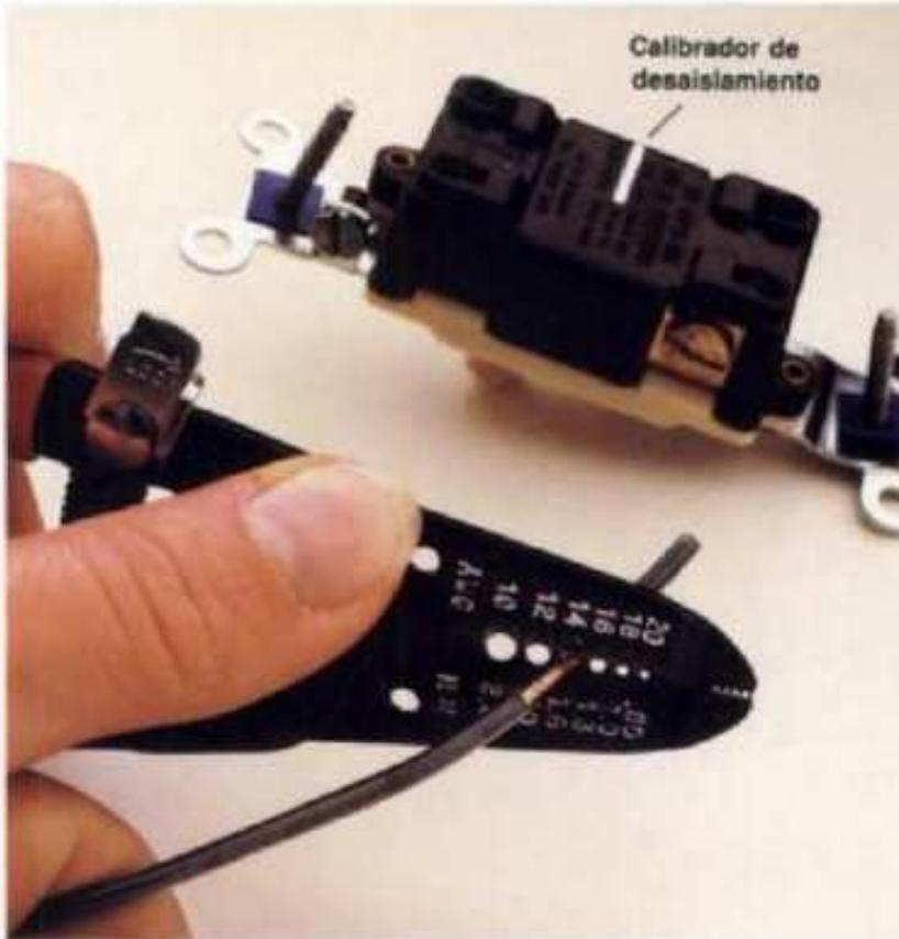
**Usar pinzas pelacables** cuando se necesite quitar el forro para conectar los alambres. El calibrador de desaislamiento de la parte de atrás de la caja de salida o del interruptor indica la longitud que hay que quitar del forro del cable. Se inserta el extremo aislado del cable dentro del agujero de las pinzas que ajuste mejor. Una vez que se aprietan las quijadas, se usa el dedo pulgar para apalancar la herramienta lateralmente y quitar el forro.
