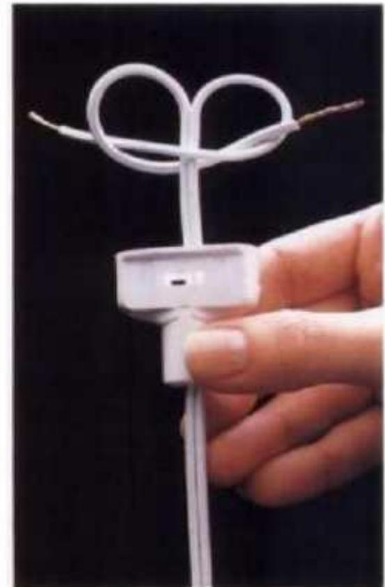
**Hacer un lazo o nudo asegurador** según se ilustra cuando se cambia una clavija o un cordón, si hay espacio en el cuerpo de la clavija. Esto evita que los cables se desprendan de la clavija si se jalan.
