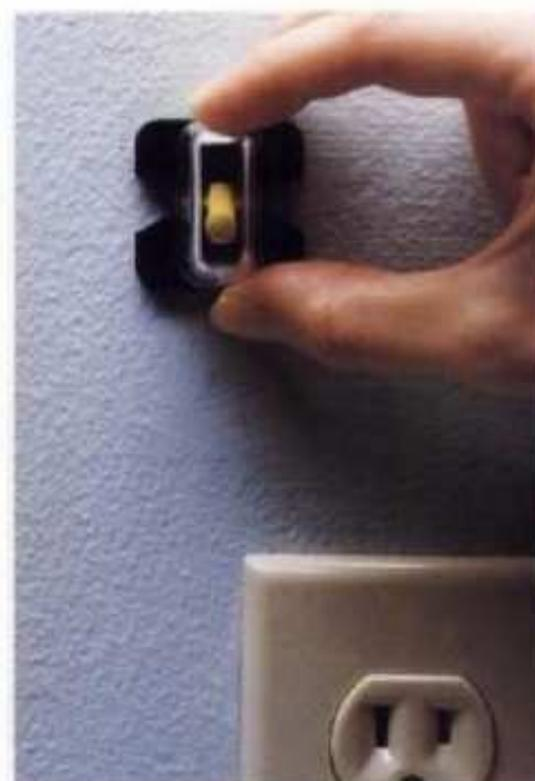
**Use un detector magnético o electrónico** para localizar clavos de acero. Pase al azar el detector sobre la pared hasta que el imán indique la presencia de un clavo en un pie derecho.
