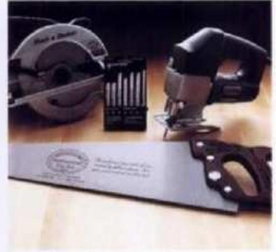
**Adquiéranse distintas sierras y seguetas** para realizar cualquier trabajo de reparación. La sierra circular es indispensable para cortar maderas gruesas para bastidores; la sierra caladora sirve para cortar formas difíciles.
