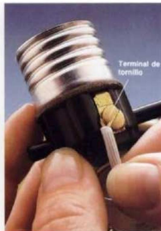
**3** Revise que no estén flojas las terminales de los alambres. Asegure de nuevo las conexiones flojas; después ensamble de nuevo la lámpara y pruébela. Si las conexiones no están flojas, se desconectan los alambres, se quita el portafoco y se continúa con el siguiente paso.
