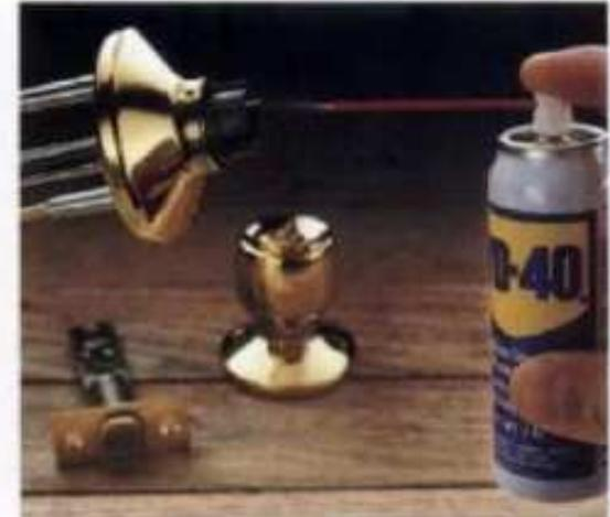
**Lubricar las cerraduras** y las bisagras una vez al año, para lo cual es necesario desarmar estos accesorios y rociar las piezas con solvente lubricante. Lubricar las cerraduras nuevas antes de instalarlas.
