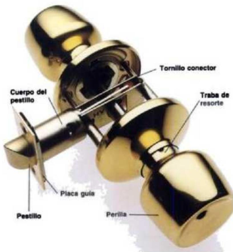
**Cerradura de paso moderna.** Quitar las manijas (sujeta con tornillos de conexión o retén de resorte). Aflojar los tornillos de retención para quitar la placa de sujeción y el eje del pestillo. Rociar lubricante y solvente en todas las piezas. Eliminar el exceso de lubricante y ensamblar de nuevo la cerradura.
