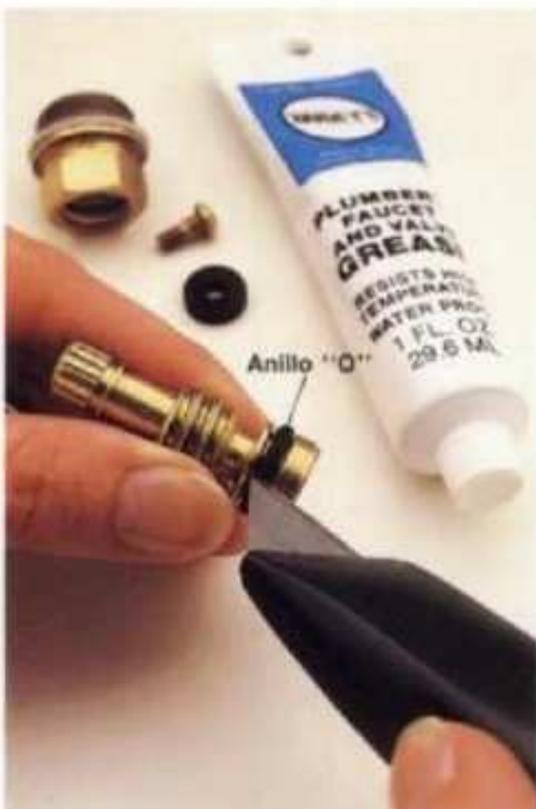
**4** Cortar con navaja el anillo "O" del vástago. Instalar un repuesto exacto del anillo "O". Untar grasa a prueba de calor en todas las piezas móviles, incluido el portamanija. Examinar el asiento de válvula (página siguiente). Si está picado, cambiar o realinar el asiento de válvula antes de ensamblar de nuevo el grifo.
