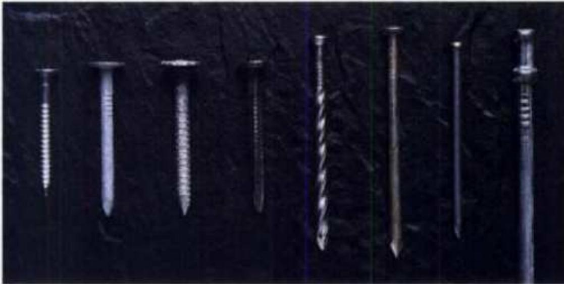
Esta colección de clavos comprende (de izquierda a derecha): clavo para paredes de yeso, clavo galvanizado para techos, clavo para sellado de techos, clavo para concreto, clavo para pisos de madera, clavo común de bastidores, clavo sin cabeza y clavo de dos cabezas.
