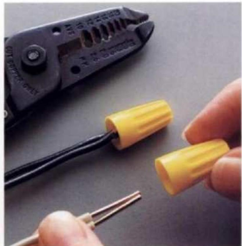
**Cómo hacer la conexión de torsión sin soldadura:** Quitar como  $\frac{5}{8}$ " del forro del alambre. Usar un conector que se adapte al tamaño y número de cables que se conectan. Mantener paralelas y juntas las puntas del alambre de cobre y enroscarlas en el conector en sentido de manecillas de reloj hasta que los alambres desnudos queden ocultos y la conexión esté firme. Tirar ligeramente en los cables para probar la conexión.
