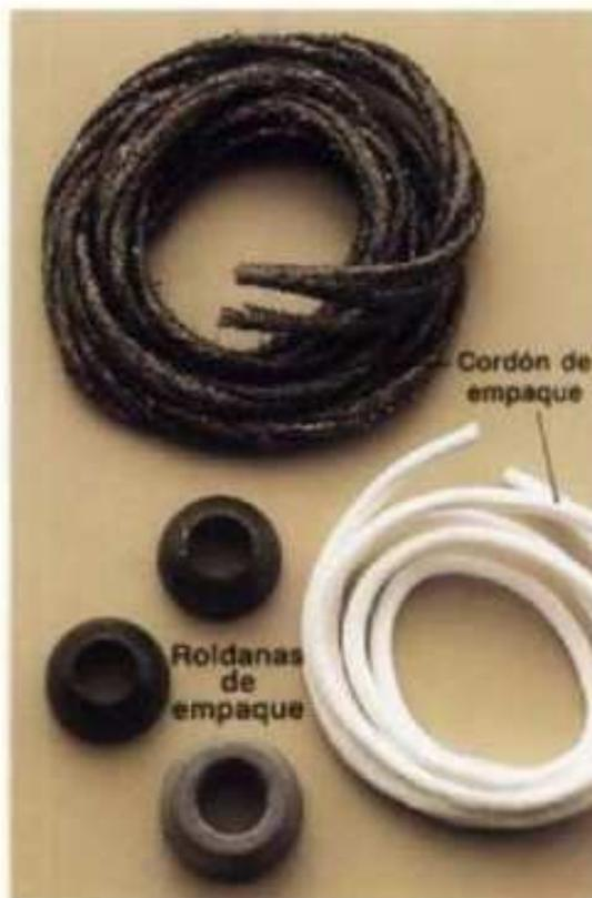
En grifos más antiguos, la roldana de empaque o el cordón de autoformación de empaque que está precisamente abajo de la tuerca de empaque, se usa en lugar de anillos "O". Cambiar la roldana de empaque, o sujetar la caña con la tuerca de empaque que aparece de frente, y revestir con 5 ó 6 vueltas de cuerda de empaque alrededor del vástago en sentido de manecillas de reloj debajo de la tuerca de empaque.
