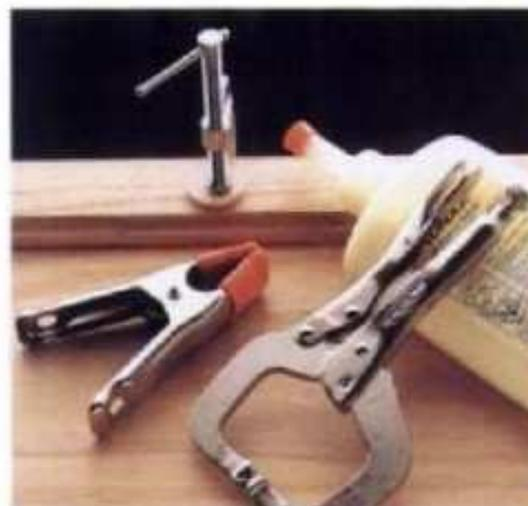
**Adquirir dispositivos para sujetar** firmemente una pieza de trabajo cuando se taladra o se lijá, o para sujetar dos piezas que se unen hasta que se seque el pegamento.
