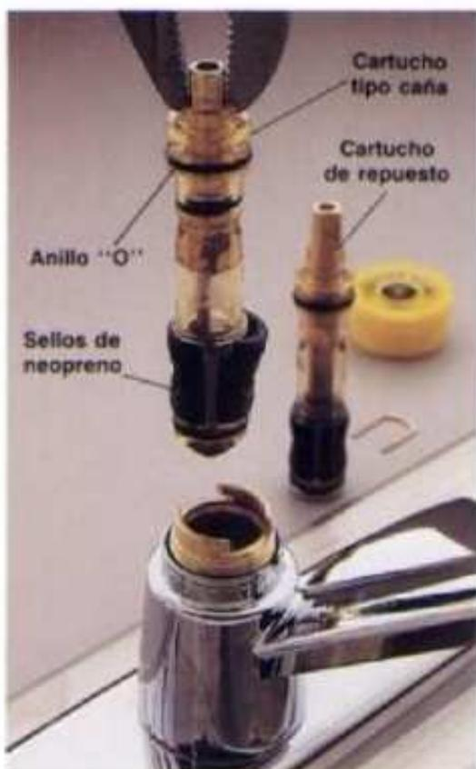
**4** Sujetar la parte superior del cartucho con pinzas ajustables. Jalar verticalmente para quitar el cartucho. Llevar consigo el cartucho usado para comprar la pieza de repuesto. Insertar el cartucho nuevo e instalar el seguro de retención.
