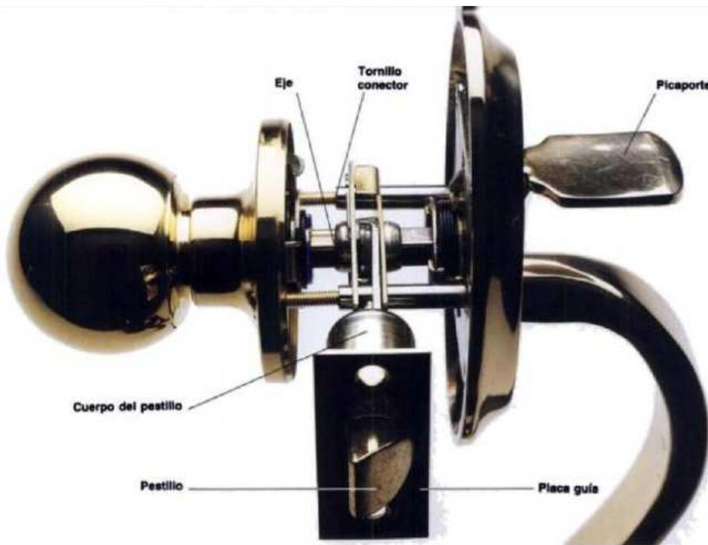
**Las cerraduras cierran** por la extensión del pestillo a través de la placa de sujeción hacia adentro de la hembra del cerrojo que está adentro del marco de la puerta. El pestillo se desplaza hacia atrás y hacia adelante por medio de un husillo o varilla de conexión accionada por el picaporte, la manija, o en donde entra la llave.
