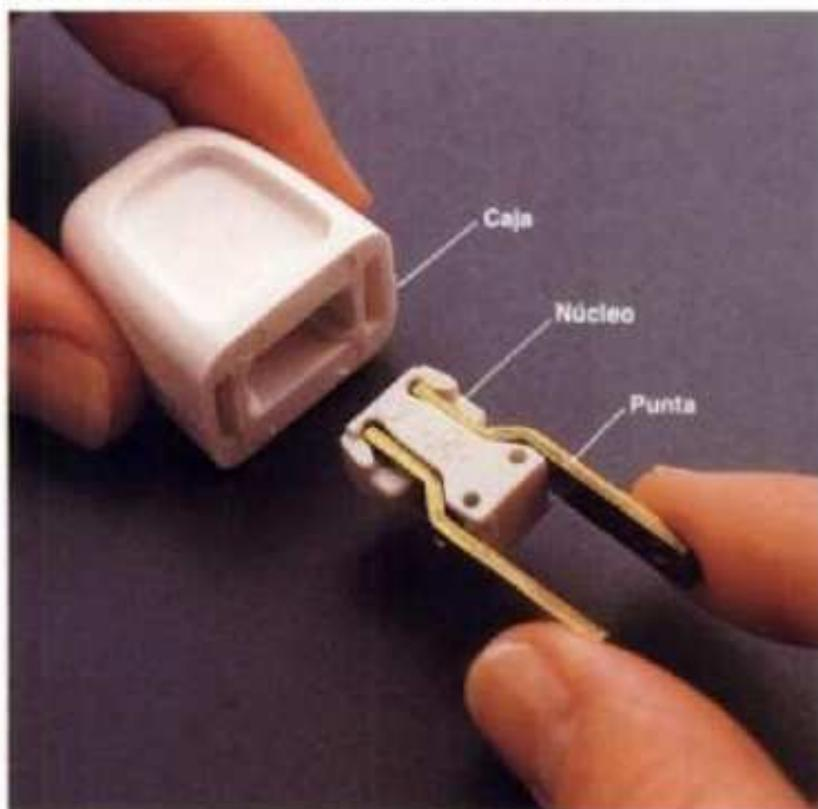
**1** Apriete con fuerza las dos espigas de la clavija nueva para juntarlas ligeramente; jale el núcleo de la clavija. Corte con las pinzas pelacables el alambre de la clavija vieja para que quede una punta cortada pareja.
