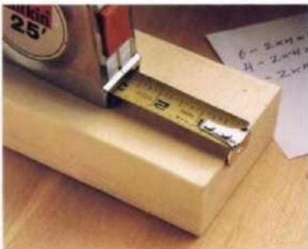
**La hoja ancha rígida** de esta cinta métrica de calidad permite medir sin necesidad de que un ayudante la sujete del otro extremo.
