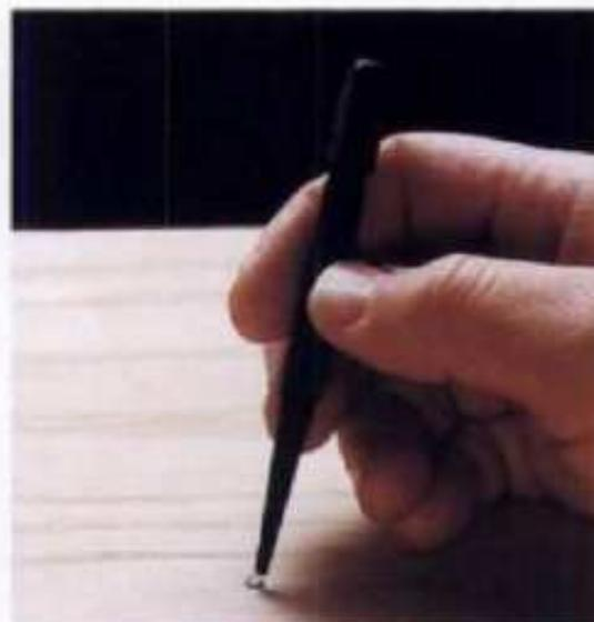
**Se evita dañar la madera** si se usa el punzón para introducir el clavo sin cabeza bajo la superficie.
