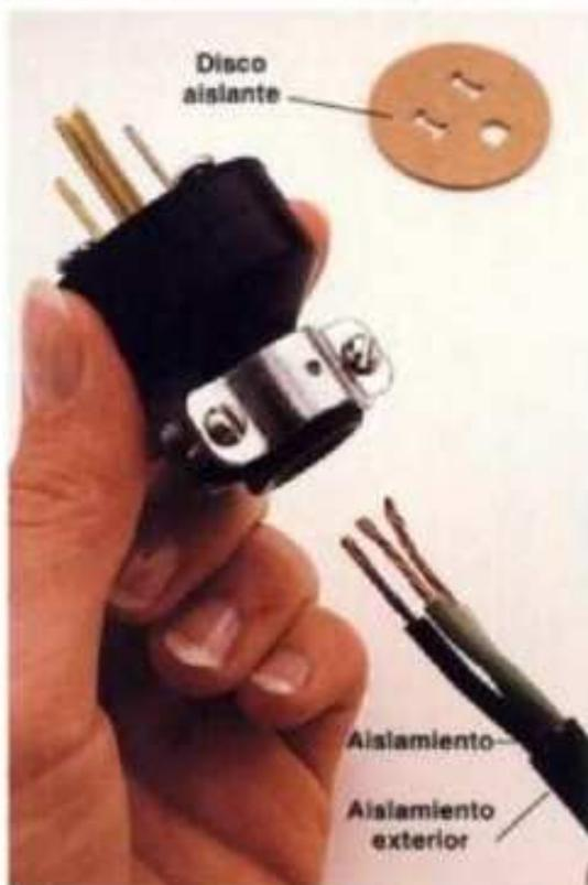
**1** Corte la clavija vieja con las pinzas pelacables y deséchela. Quite el aislante exterior del cordón redondo. Se quita aproximadamente  $\frac{3}{4}$  de pulgada del torro en cada punta del alambre. El disco aislante de la nueva clavija también se quita. El cordón se empuja por atrás de la nueva clavija.
