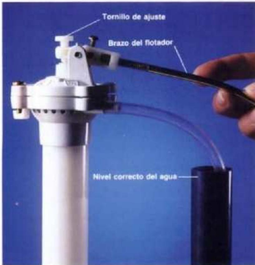
**Inodoros con flotadores de bola.** Presionar ligeramente hacia abajo el brazo del flotador. El nivel del agua del depósito debe llegar a un punto aproximado de 1/2 pulgada abajo del borde del tubo de derrame. La mayoría de las válvulas de admisión de agua tienen también tornillos de ajuste para pequeñas graduaciones del nivel del agua. Cambiar el flotador de bola si contiene agua. La bola no debe tocar las paredes del depósito.
