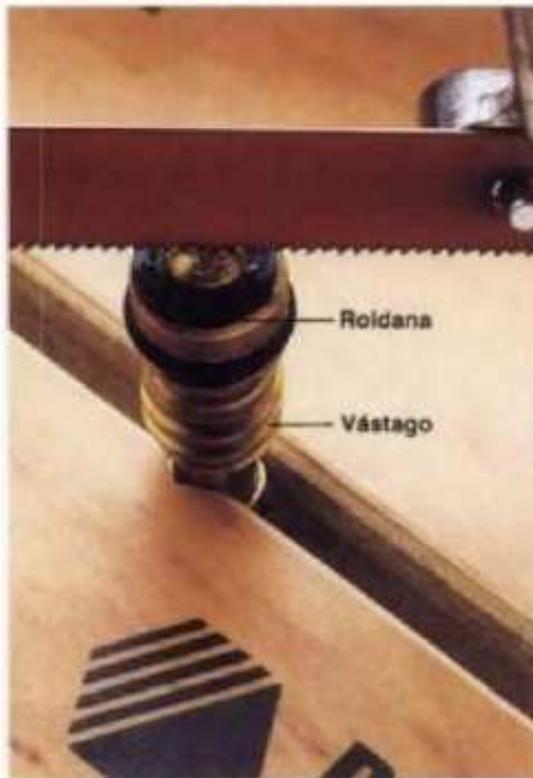
**Si se dañan las ranuras** con el desarmador de una roldana del vástago, ahondar la ranura del tornillo con una sierra para cortar metales. Si se rompe la cabeza del tornillo, apalancar para sacar la roldana y quitar el tornillo con las pinzas de punta.
