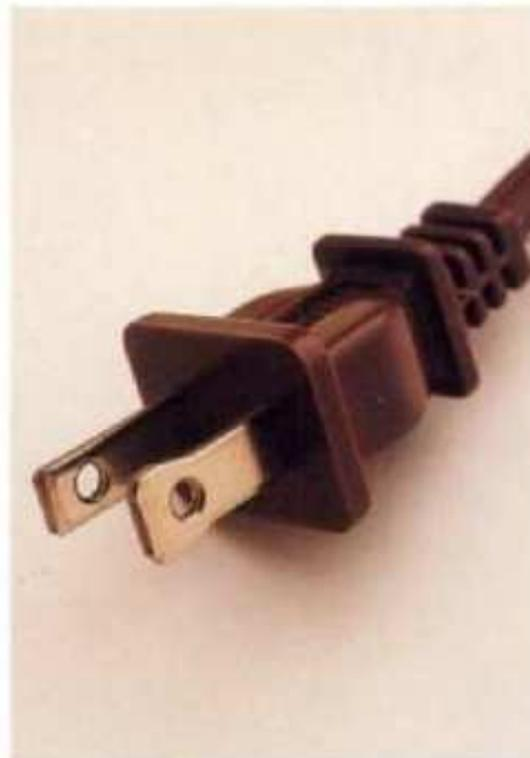
**Las clavijas polarizadas** tienen las puntas de distintos anchos para mantener la continuidad apropiada del circuito y dar protección contra choques. Si el enchufe no acepta clavijas polarizadas, no altere las puntas para adaptarlas a la caja de salida. Instale un nuevo enchufe (página 46) después de probar que la caja de salida está conectada a tierra.
