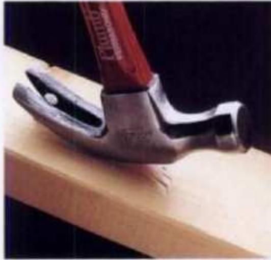
**No emplear el martillo de carpintero** como herramienta de uso general. Está diseñado solamente para clavar y sacar clavos.
