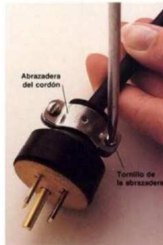
**3** Apriete los tornillos firmemente, asegurándose de que los alambres de cobre no se tocan. Cambiar el disco aislante. Si la clavija tiene grapa para el cordón, apretar firmemente sus tornillos.
