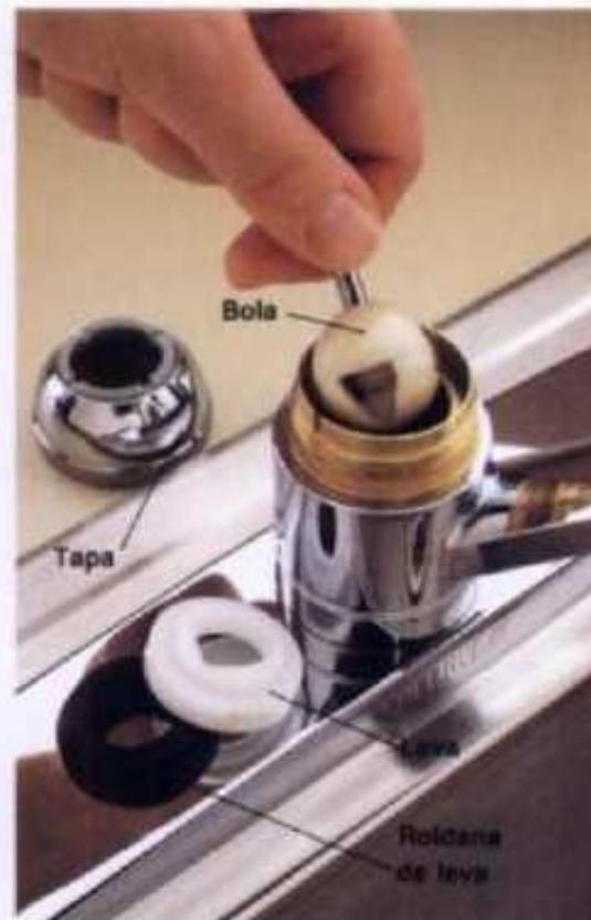
**6** Instalar los nuevos resortes y asientos de válvula, y la nueva bola, roldana de leva y leva. Ensamblar nuevamente el grifo.
