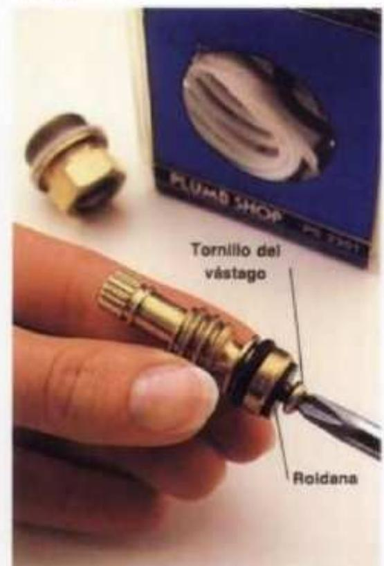
**3** Desenroscar el tornillo de bronce del vástago y con una palanca levantar la roldana usada. Colocar nuevamente la roldana con un duplicado exacto. Cambiar también el tornillo de bronce si presenta señales de desgaste. Los juegos de piezas de repuesto vienen con un amplio surtido de roldanas y tornillos de bronce.
