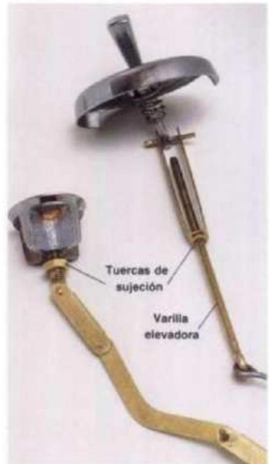
**3** Las tuercas de sujeción permiten ajustar la posición del tapón. Si el desagüe de la bañera tiene fuga cuando el tapón está cerrado, aflojar en ese caso la tuerca de sujeción y enroscar el tapón hacia abajo. Si la bañera se desagua, en ese caso el tapón se atornilla hacia arriba. Mediante el cambio de posición de la varilla elevadora, se hacen ajustes mayores.
