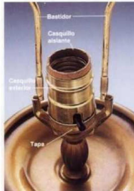
**6** El casquillo aislante y el casquillo metálico exterior se deslizan por arriba del portafoco de manera que éste y las terminales roscadas queden completamente tapados; el interruptor se debe acomodar adentro de la ranura del casquillo. Apriete el conjunto del portafoco dentro de su base metálica. Coloque de nuevo el portapantalla, el foco y la pantalla.
