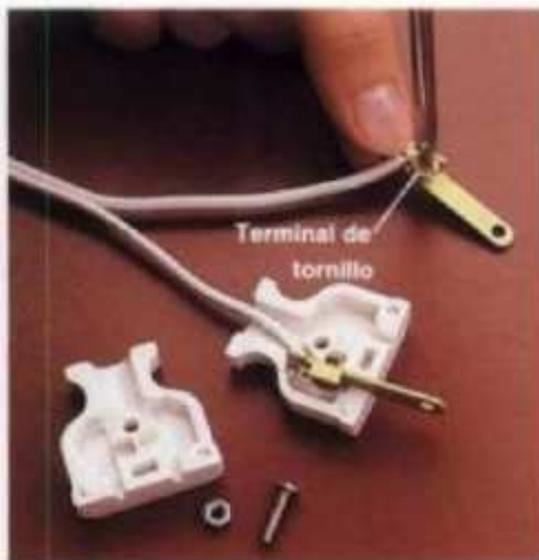
**2** Quite la tapa de la caja. Tuerza y junte los hilos sueltos del alambre de cobre desnudo. Enganche los alambres de cobre en sentido de manecillas de reloj alrededor de las terminales roscadas y apriételas firmemente.
