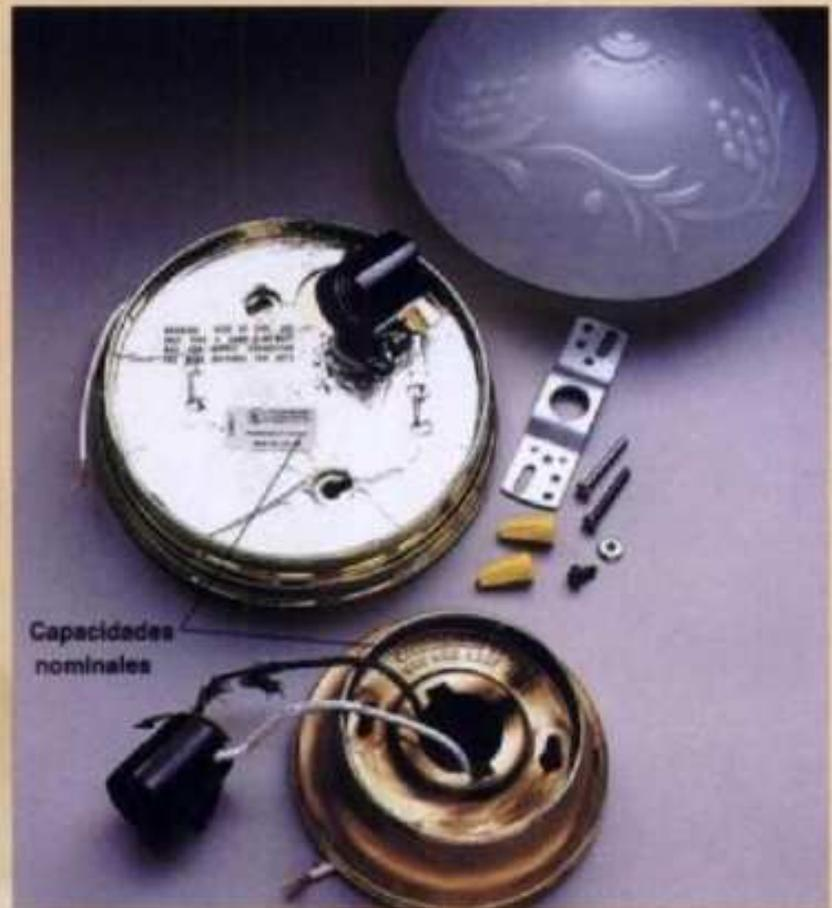
**4** Seleccione un repuesto con las mismas capacidades normales del accesorio viejo. Para evitar que se tenga que reparar el cielo raso, adquiera un anillo portafoco con la base tan ancha o más ancha que la base del accesorio viejo. Siga las instrucciones del fabricante para hacer la instalación.
