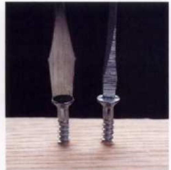
Seleccionar el desarmador apropiado a la ranura de la cabeza del tornillo. La hoja ancha del desarmador de la derecha puede zafarse y dañar la cabeza del tornillo.
