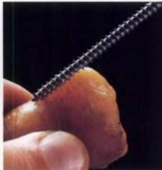
Lubricar el tornillo con cera de abeja para facilitar su introducción, ya sea con desarmador manual o con atornillador eléctrico.
