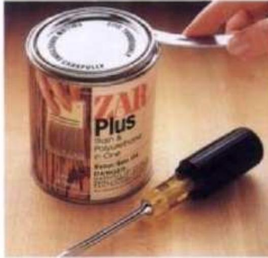
**No usar desarmadores** como cinceles o palancas. Un desarmador con la cuña doblada o con la punta averiada puede zafarse y dañar la pieza de trabajo.
