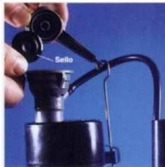
**3** Cambiar el asiento de válvula. Si el conjunto está demasiado desgastado, cambiar toda la válvula de admisión.
