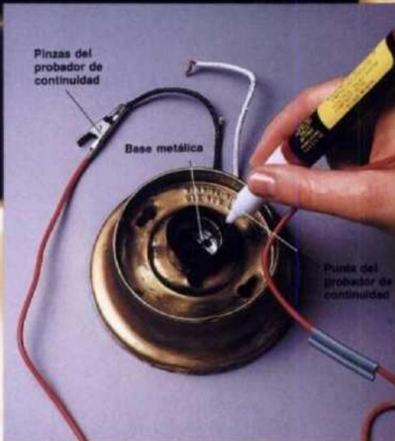
**3** Destuerza los alambres para quitar el anillo portafoco. Ponga las pinzas del probador de continuidad en contacto con el alambre negro desnudo y con la otra punta toque la lengüeta metálica de contacto. Pase las pinzas de contacto al alambre blanco y toque con la punta la base metálica del portafoco. Si el probador no se enciende en ningún punto de contacto, en ese caso se necesita cambiar el accesorio.
