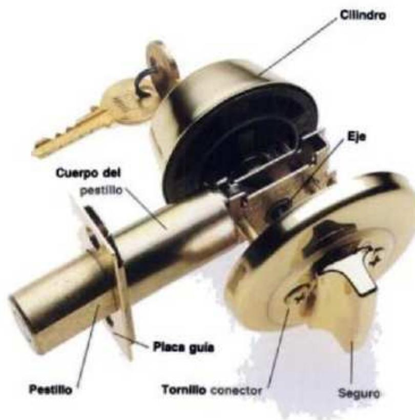
**Cerraduras de seguridad.** Aflojar los tornillos de conexión para quitar los cilindros interiores y exteriores. Se aflojan los tornillos de retención para quitar la placa de sujeción y el eje del pestillo. Rociar lubricante y solvente en todas las piezas. El lubricante sobrante se quita y se ensambla de nuevo la cerradura.
