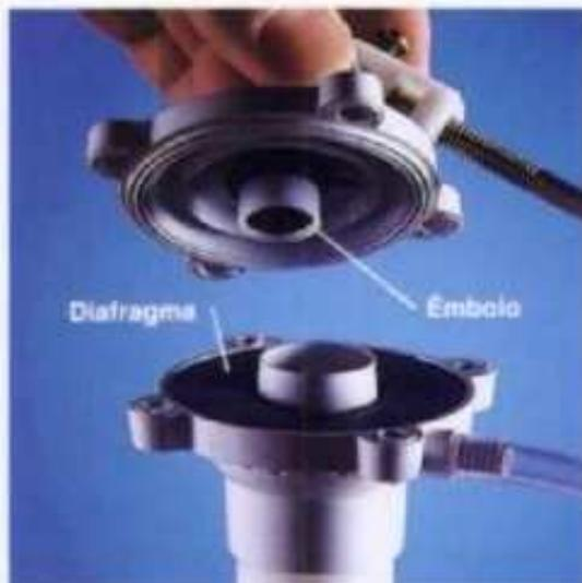
**2** Separar el brazo del flotador de la válvula de admisión de agua con la tapa ciega fija. Examinar si hay desgaste en el diafragma y el émbolo de la válvula.
