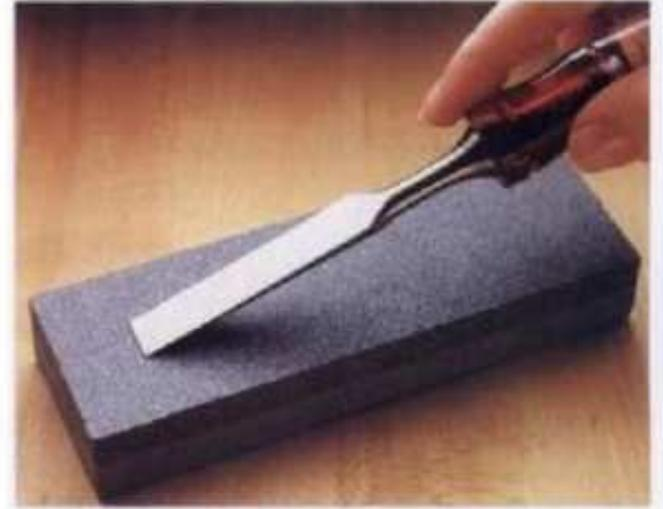
**Manténganse afilados** los cinceles, escoplos y demás herramientas de corte. Es peligroso forzar herramientas desafiladas.
