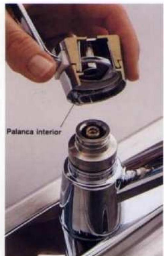
**6** Alzar la palanca de la manija al mismo tiempo que se sujeta firmemente el collarín. Con el collarín sujetado en ángulo, deslizar el borde plano de la palanca interior por arriba del borde de la tuerca de retención. Instalar nuevamente el tornillo de la manija y la tapa índice.
