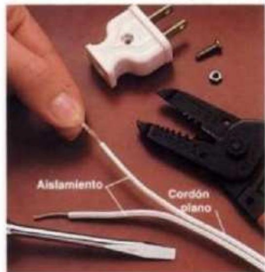
**1** Corte con las pinzas pelacables la clavija vieja y jale hacia los lados los dos alambres del cordón plano para separarlos. Con las pinzas pelacables quite a cada cable aproximadamente  $\frac{3}{4}$  de pulgada del aislante.
