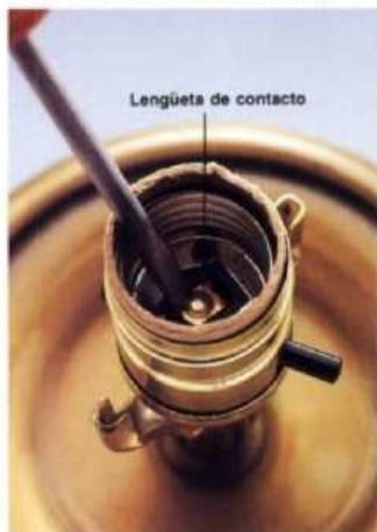
**1** Desenchufe la lámpara. Quite la pantalla, el foco y el soporte (portapantalla). Con un desarmador pequeño se raspa la lengüeta de contacto. Levante ligeramente con el desarmador la lengüeta de contacto si se encuentra aplanada dentro del portafoco. Cambie el foco, enchufe la clavija y pruebe. Si la lámpara no enciende, entonces se desenchufa, se le quita el foco y se continúa con el siguiente paso.
