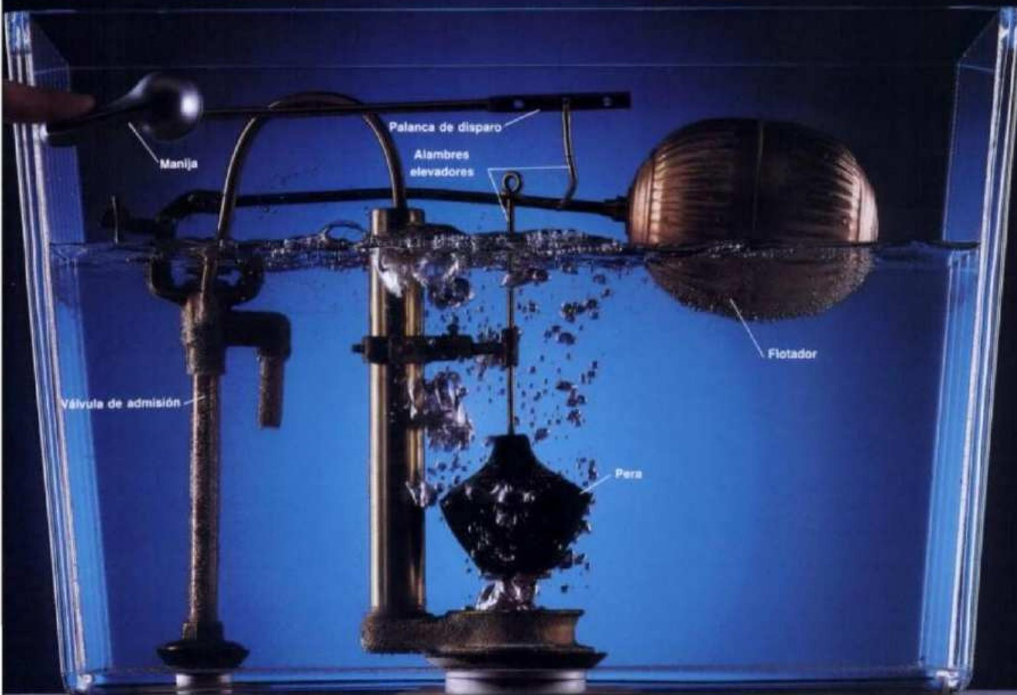
Todos los inodoros con depósito de agua funcionan de la misma manera. Al empujar la manija (1), la palanca de disparo (2) fijada a cadena alzadora o a los alambres elevadores (3) levanta la bola del depósito (4) o chapaleta del fondo del depósito (inodoro). El agua se
