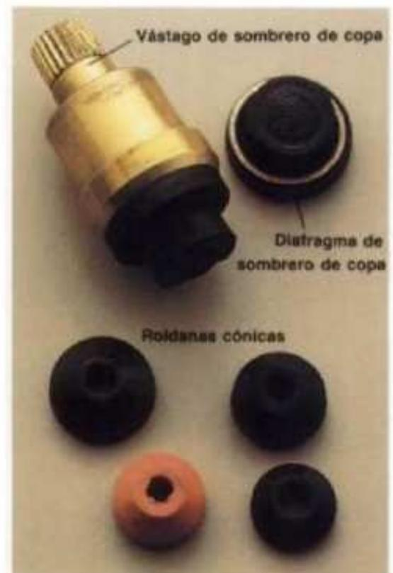
**Variaciones de la roldana:** un grifo de vástago en forma de sombrero de copa usa un diafragma del mismo estilo. Basta con empujar rápidamente una roldana de diafragma por arriba de la punta del vástago para corregir fugas. Un vástago de presión inversa usa una roldana ahusada que se adapta con el lado ahusado de frente al cuerpo de la caña.
