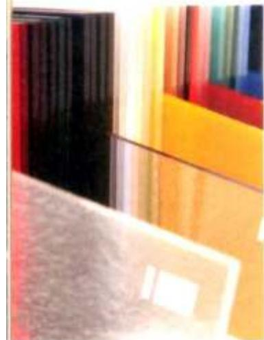
El acrílico es un tipo de plástico que se obtiene de la polimerización de moléculas de metacrilato de metilo, conformando un compuesto conocido como polimetilmetacrilato o PMMA.
