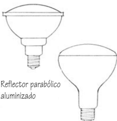
Reflector parabólico aluminizado
