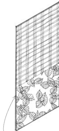
Los paneles de resina se venden en forma de láminas transparentes o traslúcidas, con materiales y capas embebidos, y también como láminas texturizadas. Algunos están fabricados con resinas recicladas; los que no incorporan otros materiales son más fáciles de reciclar. Estos paneles se pueden montar directamente como paredes divisorias o sobre un paramento con fijaciones de tornillería.
