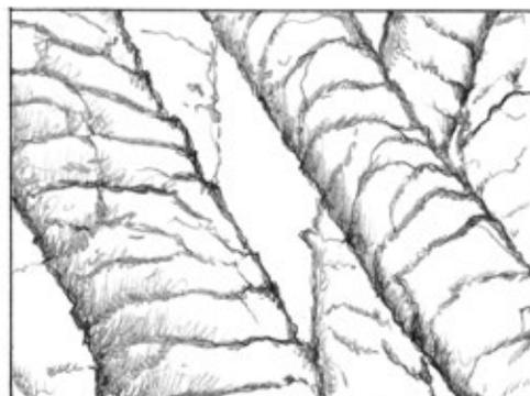
Imagen microscópica de fibras de lana.
