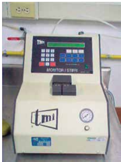
Figura 5.6. Monitor Stiffi (SCT) (Laboratorio Cenpack)
