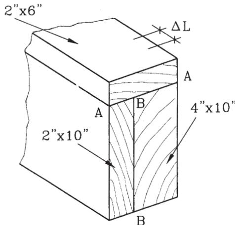
**3.09** Cuatro secciones de madera de  $5 \times 20$  cm se combinan para formar una viga según las tres alternativas siguientes. Compare los momentos admisibles y saque conclusiones. Se supone que las uniones están hechas en forma adecuada. (Respuesta:  $M_{ad}/\sigma_{ad} = 2556, 1333, 2267$ )
