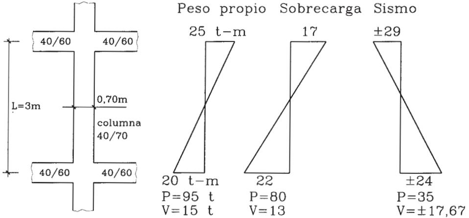
**4.31** Diseñar la columna de hormigón armado de modo de asegurar un tipo de rotura dúctil. Se pide usar sección cuadrada y cálculo a la rotura. Los materiales son: hormigón  $f_c' = 240 \text{ kg/cm}^2$ , y acero A63-42H. Los estados de carga son:
