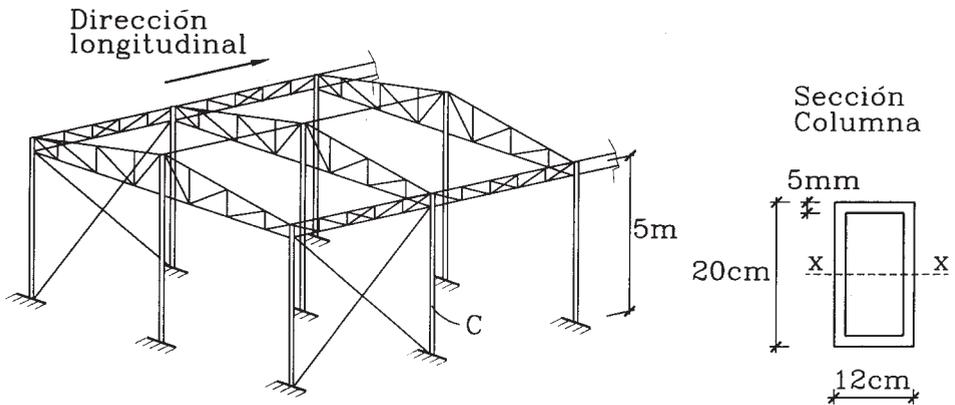
**2.52** La figura muestra parte de una estructura industrial de acero A37-24ES. Las columnas exteriores son perfiles IN20×20 y las interiores son perfiles HN20×33,8. Las columnas pueden suponerse empotradas a las fundaciones de hormigón armado. Determinar la orientación más conveniente de los perfiles y sus cargas axiales admisibles ( $C_i$  = columna interior típica,  $C_e$  = columna exterior típica).
