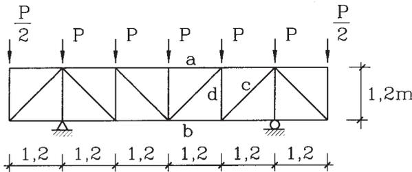
**2.48** Diseñar los elementos de un reticulado para la techumbre de un galpón industrial. Hay tres vigas para grúas vinculadas al cordón inferior en  $L_2$ ,  $L_2'$  y  $L_5$ , con cargas de 2903, 2903 y 5580 kg respectivamente. Además, se tienen las siguientes cargas de diseño: peso propio = estructura + cubierta =  $63,65 \text{ kg/m}^2$ , sobrecarga = nieve =  $200 \text{ kg/m}^2$ . Diseñar también el nudo  $L_1$  (unión soldada). Usar acero A37-24ES y electrodos E40XX.
