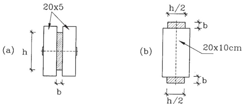
**3.31** Determinar el máximo valor de  $P$  para el que se puede usar la viga de la figura, si se sabe que la tensión máxima en el borde superior de las piezas de madera no debe superar los  $50 \text{ kg/cm}^2$  al mismo tiempo que la tensión máxima en el borde inferior de la pieza de acero de  $1 \times 10 \text{ cm}$  no supere los  $1200 \text{ kg/cm}^2$ . Usar  $E_s = 2100 \text{ ton/cm}^2$  y  $E_m = 140 \text{ ton/cm}^2$ .
