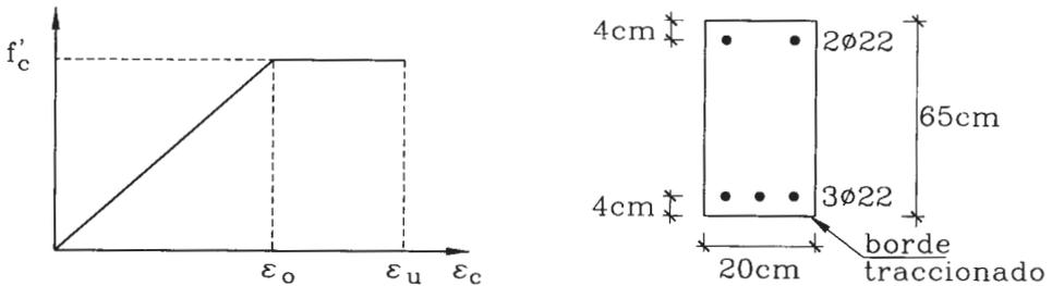
**3.68** La viga de hormigón armado de la figura se ha ejecutado con hormigón de  $f'_c = 280$  kg/cm<sup>2</sup> y acero de  $\sigma_y = 4200$  kg/cm<sup>2</sup>. Esta viga se va a someter en el laboratorio a un ensayo a rotura. Determine la carga P para la cual Ud. espera que la viga colapse. (Respuesta: Carga de colapso nominal  $P_u = 1,98$  ton)
