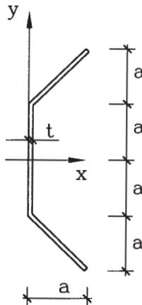
**3.03** Demostrar que la posición del centro de corte de la sección de la figura está dada por:
