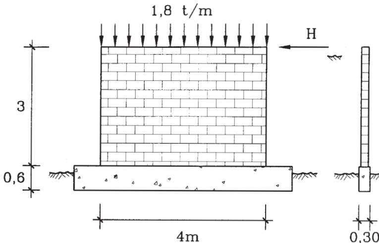
**4.07** Diseñar la fundación de sección cuadrada de lado  $d$  para las solicitaciones indicadas si la tensión admisible en el terreno es de  $2 \text{ kg/cm}^2$ , y factor de seguridad al volcamiento de 1,5. (Respuesta:  $d = 177 \text{ cm}$ ,  $\sigma = 1,34 \text{ kg/cm}^2$ ).
