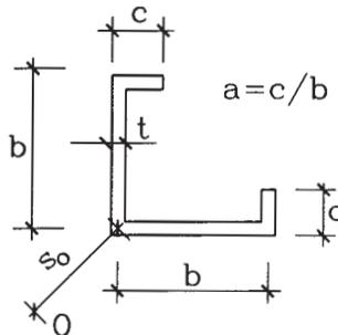
**3.04** Para la sección que se muestra en la figura, determine la posición del centro de corte. Grafique la distribución de tensiones tangenciales debidas a una carga  $V$  paralela al eje vertical para  $a=5$ ,  $h=20$ ,  $b=10$ , y  $t=0,5$  cm. La respuesta es:
