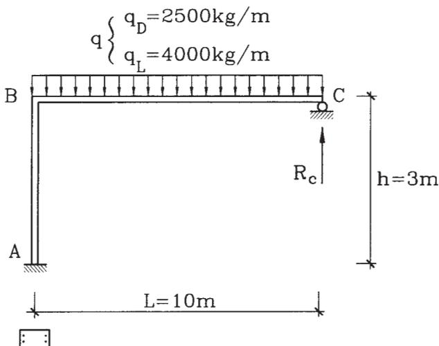
**4.30** Para la columna de la figura que forma parte de una estructura de marco. Se pide diseñar la armadura longitudinal suponiendo que no hay pandeo. Los estados de carga de peso propio, sobrecarga y sismo, son los indicados. Las fuerzas axiales son de compresión. Los materiales son: acero A63-42H y hormigón  $f_c' = 280 \text{ kg/cm}^2$ .
