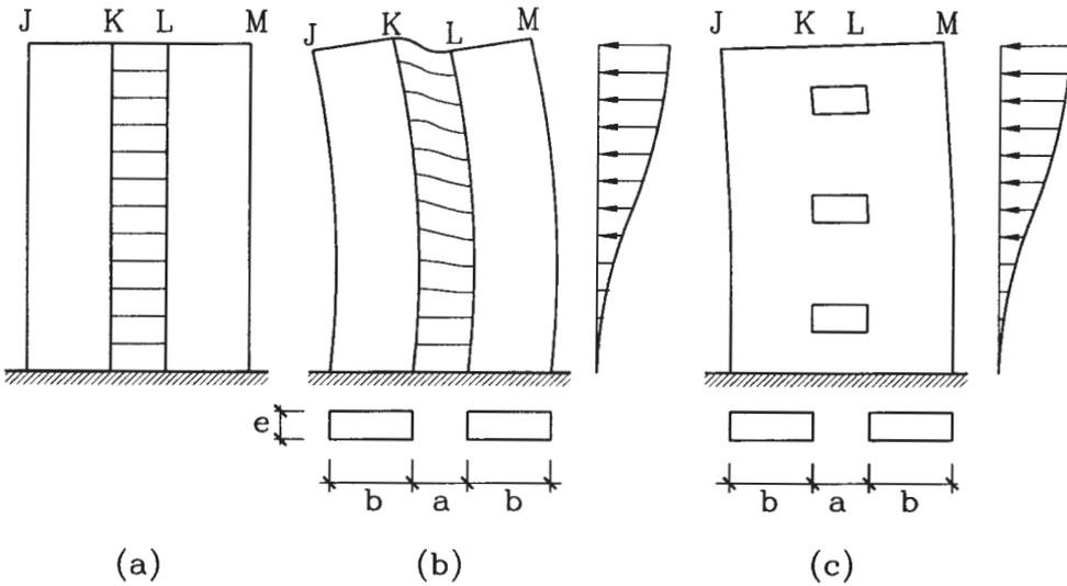
**Figura 3.23** Muros acoplados de hormigón armado: (a) estructura sin carga lateral, (b) estructura con acoplamiento muy flexible, (c) estructura con acoplamiento muy rígido. En (b) y (c) actúan cargas sísmicas laterales equivalentes
