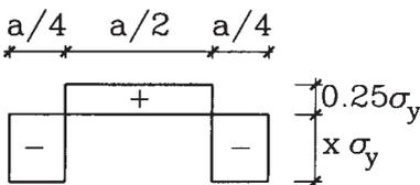
**2.33** Determine a través de un gráfico, la curva que entrega la tensión crítica en función de  $kL/r$ , para una columna de sección doble-T con la distribución de tensiones iniciales que se muestra. Determine primero la curva  $\sigma-\epsilon$  alterada, debido a las tensiones iniciales.
