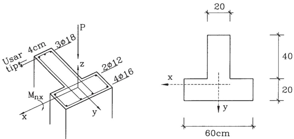
4.25 Dibujar la curva  $M-\phi$  de la sección de la figura. Encontrar la ductilidad de curvatura. ¿Cómo cambia la ductilidad de curvatura de la sección si sobre ella actúa una carga axial de compresión de 40 ton? Usar las mismas propiedades de los materiales del problema anterior.
