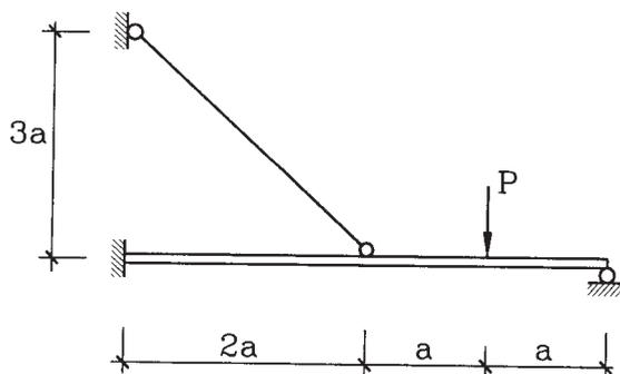
**3.49** Encontrar la carga de colapso y el diagrama de momentos correspondientes para la estructura de la figura. El momento plástico de las vigas es  $M_p$  y el de las columnas  $5/6 M_p$ .
