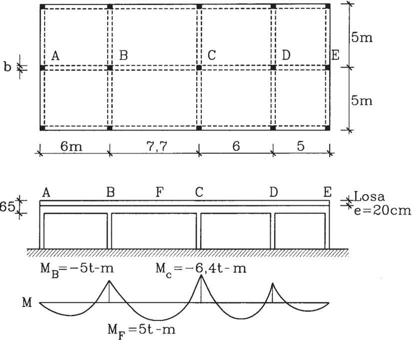
**3.60** Diseñar la enfierradura de una losa destinada a soportar el peso de un corredor de 3 m de ancho, y una sobrecarga de  $400 \text{ kg/m}^2$ . Las tensiones admisibles son  $\sigma_s^{\text{adm}} = 1600 \text{ kg/cm}^2$  y  $\sigma_c^{\text{adm}} = 80 \text{ kg/cm}^2$ . a) Determine el espesor de la losa y la enfierradura, si se ocupa una cuantía igual al 60% de la cuantía de balance; b) si el espesor de la losa es de 15 cm.
