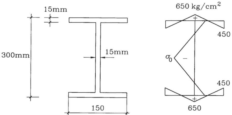
**2.08** Una columna de material elastoplástico se somete a un ensayo de compresión axial. Determinar el valor de  $\alpha$  que debe tener la distribución de tensiones iniciales y la curva  $\sigma$ - $\epsilon$  real que se obtiene del ensayo de compresión. No hay pandeo.
