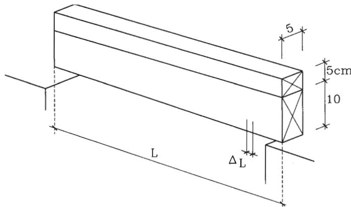
**3.11** Una viga en flexión tiene la sección de la figura. Determinar la tensión de cizalle máxima para un esfuerzo de corte  $V$  dado. (Respuesta:  $V/22,8$ )
