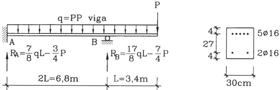
**3.72** Determinar el momento flector admisible de la viga T de la figura. Incluir todas las armaduras. Las tensiones admisibles son 1800 y 120  $\text{kg/cm}^2$  en el acero y el hormigón respectivamente. Determinar la capacidad última nominal flexural. Estimar el factor seguridad como  $M_n/M_{adm}$ . Utilizando criterio de diseño último determinar la resistencia de corte última nominal de la viga. Usar  $f'_c = 300$  y  $\sigma_y = 2800 \text{ kg/cm}^2$ .
