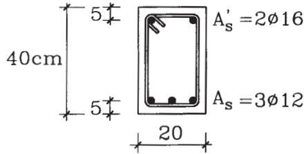
4.26 En una columna de hormigón armado con la sección indicada en la figura, el análisis estructural indica que el momento de diseño es  $M_U = 9000 \text{ kg-m}$ . Determinar el rango de valores de la carga de compresión última de diseño  $P_U$  para el cual puede usarse esta columna. Usar ábacos de diseño con  $f'_c = 190 \text{ kg/cm}^2$  A44-28H.
