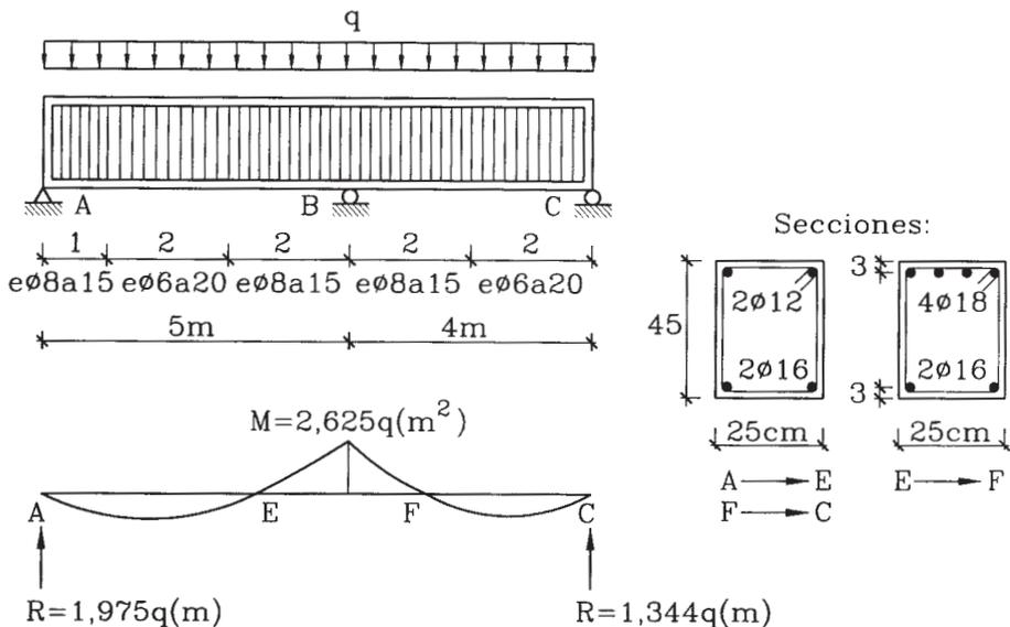
**3.71** La viga de hormigón armado de la figura debe resistir una carga  $P$  compuesta de 400 kg debido a cargas de peso propio de otro elemento estructural, y de 500 kg debido a sobrecarga. Determinar la armadura por esfuerzo de corte en la sección B. Verificar si la armadura de flexión en la sección B es adecuada. Usar peso del hormigón  $= 2,4 \text{ ton/m}^3$ ,  $f'_c = 190 \text{ kg/cm}^2$ ,  $\epsilon_u = 0,003$ , acero A44-28H,  $E_s = 2100 \text{ ton/cm}^2$ .
