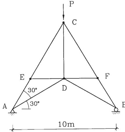
**2.47** Diseñar las barras a, b, c y d de la viga enrejada de la figura, usando perfiles de acero A37-24ES. Las conexiones serán soldadas. Ocupar elementos factibles de ser conectados.  $P = 12$  ton.
