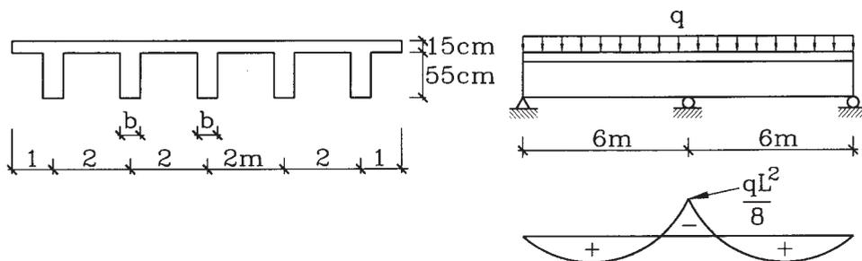
**3.59** Las figuras muestran la planta de un edificio de hormigón armado, la elevación, y el diagrama de momentos de la viga longitudinal interior. Determinar el ancho  $b$  (constante para toda la viga) y la armadura requerida en las secciones B, C y F. Usar una tensión admisible de compresión en el hormigón de  $80 \text{ kg/cm}^2$  y tensión admisible en el acero de  $1600 \text{ kg/cm}^2$ .  $E_s/E_c = 10$ .
