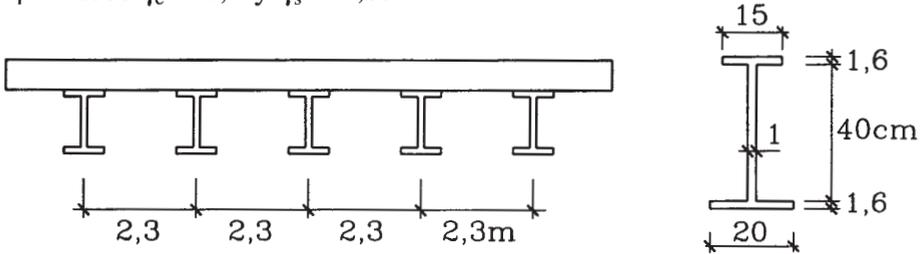
**3.38** Determinar el momento flector que produce la iniciación de la fluencia en la fibra más solicitada de la sección de la figura. Acero A37-24ES. (Respuesta:  $15,9 \text{ ton}\cdot\text{m}$ )
