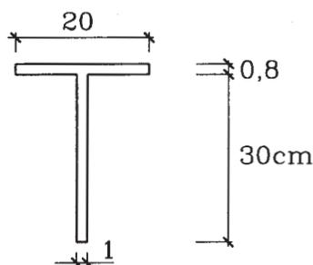
**3.12** La viga de la figura se conforma con cuatro piezas de madera unidas por clavos espaciados cada 30 cm a lo largo de ella. Determinar la fuerza de corte que debe absorber cada clavo en la sección más crítica de la viga. (Respuesta: 257, 416 kg)
