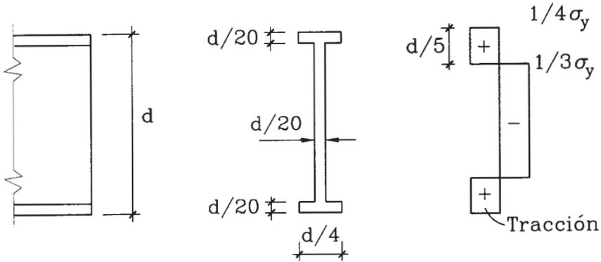
**2.34** Determine a través de un gráfico la curva que entrega la tensión crítica en función de  $kL/r$  para la siguiente sección, con tensiones iniciales de variación sinusoidal. Determine primero la curva  $\sigma-\epsilon$  debido a estas tensiones.
