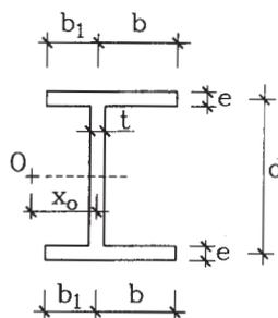
**3.06** Demostrar que la posición del centro de corte de la sección de la figura está dada por:
