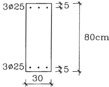
**3.55** La sección de la figura se somete a un momento flector de 20 ton-m. Determinar la tensión de compresión máxima en el hormigón y las tensiones en ambas armaduras. Suponer comportamiento lineal elástico de los materiales  $E_s = 2.100.000$ ,  $E_c = 240.000$  kg/cm<sup>2</sup>. (Respuesta: -55, -309, y 1397 kg/cm<sup>2</sup>)
