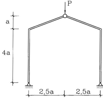
**3.50** Determinar la carga  $P_u$  de colapso para el marco de la figura. La viga y la columna son perfil IN20×30,6. El material es acero A37-24ES. (Respuesta:  $P_u = 2 M_p/3$ )
