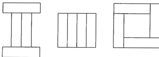
**3.10** Para formar una viga de madera se unirán mediante un pegamento dos piezas de las dimensiones indicadas. Determinar la fuerza  $F$  que debe transmitirse a través del pegamento en una longitud  $\Delta L$  de viga, de modo que las dos piezas actúen en conjunto como un sólo elemento. Determinar  $F$  en la sección más crítica sometida a un esfuerzo de corte dado  $V$ . (Respuesta:  $V \cdot \Delta L / 11,25$ )
