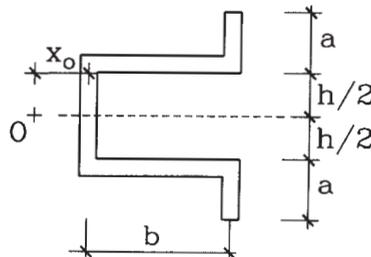
**3.05** Demostrar que la posición del centro de corte de la sección de la figura está dada por:
