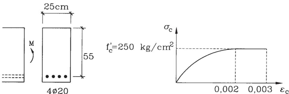
**3.66** Para la viga de la figura, de sección 25×40 cm, se pide calcular el refuerzo de flexión necesario en la sección más solicitada por flexión y el refuerzo para esfuerzo de corte en la sección del apoyo de mayor reacción. Usar diseño en rotura. Usar: peso específico del hormigón = 2,4 ton/m<sup>3</sup>,  $f'_c = 250$  kg/cm<sup>2</sup>, sobrecarga = 1400 kg/m,  $\sigma_y = 2800$  kg/cm<sup>2</sup>,  $d = 37$  cm.
