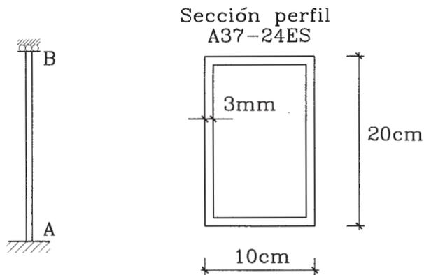
**2.41** Calcule la carga crítica de pandeo elástico para la columna de la figura.
