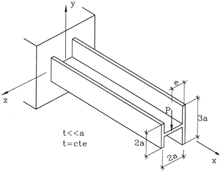
**3.02** Determinar la posición del centro de corte del perfil de la figura. El espesor  $t$  es constante y delgado.
