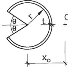
**3.07** Determine la posición del centro de corte de la sección dada. Considerar espesor constante y muy delgado. (Respuesta:  $x_o = 5,61\text{cm}$ )
