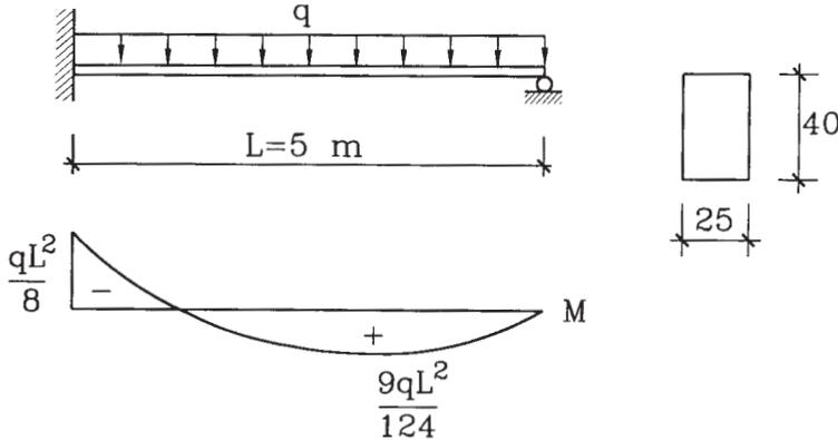
**3.67** Calcular el momento último nominal de la viga de hormigón armado de la figura. El acero es de calidad A44-28H, puede modelarse como elastoplástico, y tiene  $E_s = 2.100.000$  kg/cm<sup>2</sup>. El hormigón tiene la relación tensión deformación que ilustra la figura, con  $f'_c = 250$  kg/cm<sup>2</sup>,  $\epsilon_o = 0,0015$  y  $\epsilon_u = 0,003$ . (Respuesta: 18,58 ton-m)
