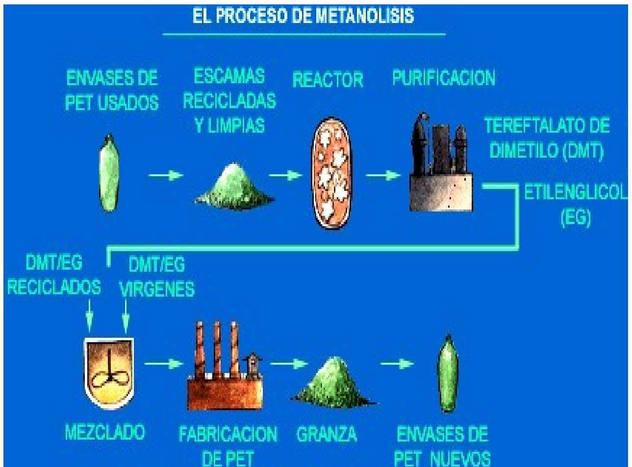
7- Figura 3: esquema del proceso de metanolisis (método químico para el reciclado del PET)
