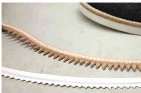
Cercos prefabricados: arriba, un cerco de cuero natural cosido; abajo, un cerco de goma EVA blanco.
