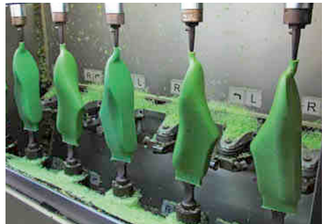
Hormas de polietileno durante su proceso de fabricación. Foto: Innolux group.
