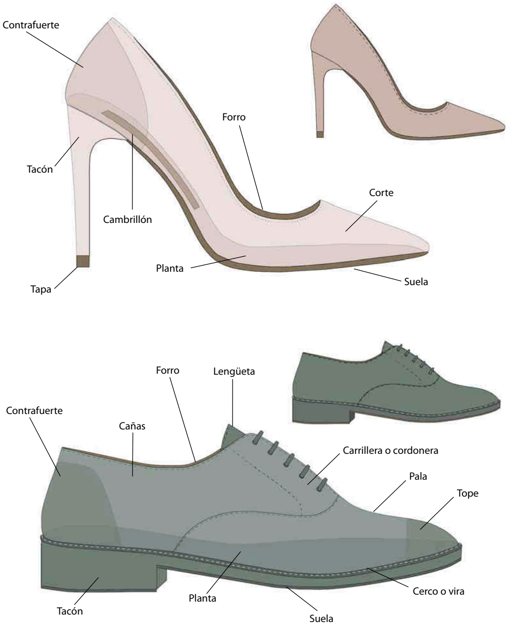
Esquemas de un zapato de tacón y otro de cordones con estructuras complejas.
