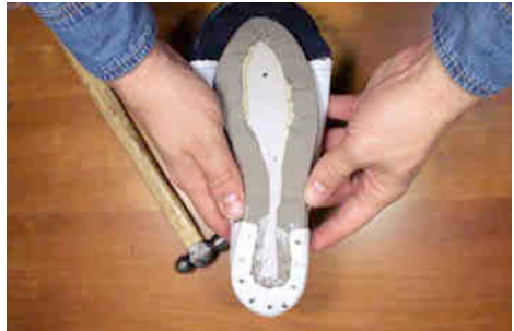
Vista de la planta con el forro y el contrafuerte montados durante el proceso de armado.
