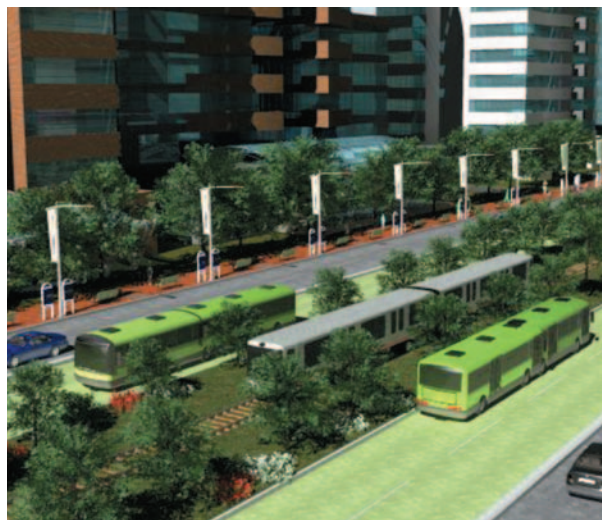
Figura 2.3.1c Los carriles exclusivos para buses proveen la mayor eficiencia y garantizan la mayor puntualidad en la operación de una línea de transporte colectivo, porque no están supeditados a las condiciones del resto de tránsito.
