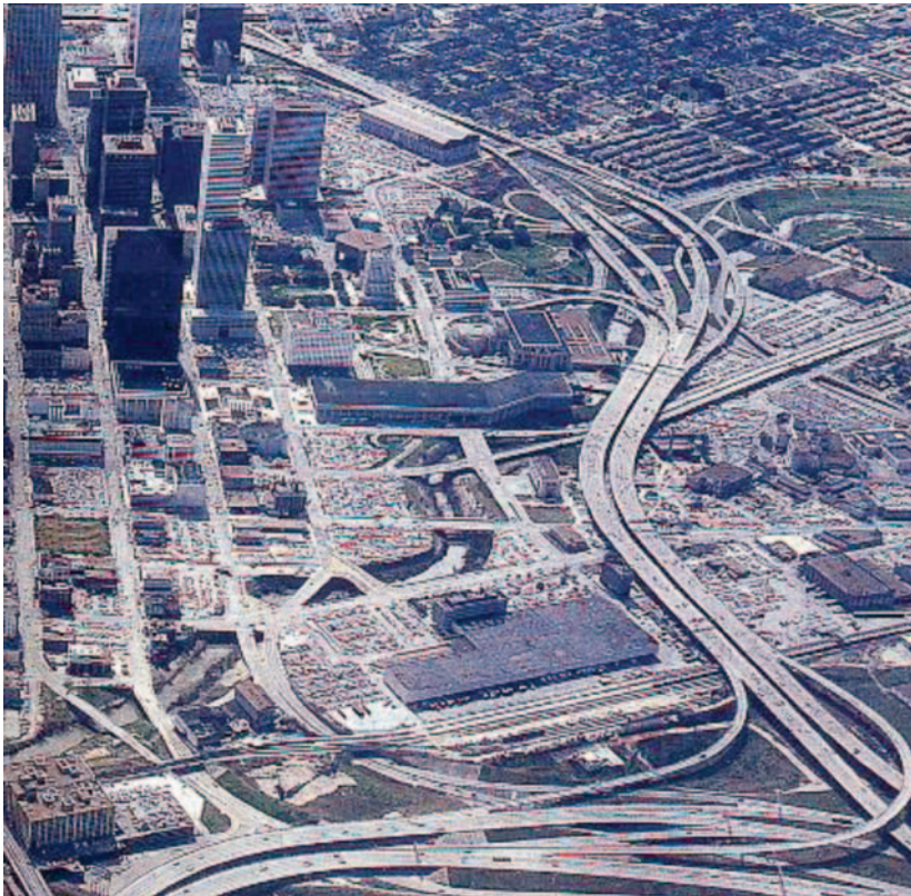
Figura 2.5.5g Los pasos a desnivel direccionales resuelven todos los movimientos a desnivel de manera directa y siguiendo el flujo dinámico del tránsito. (Fuente: Alex MacLean, La fotografía del territorio).
