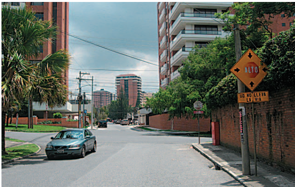
Figura 2.5.1b La implementación de altos para todos los accesos a una intersección no es común en Centroamérica y República Dominicana y únicamente es recomendable en intersecciones sin mucho volumen vehicular.
