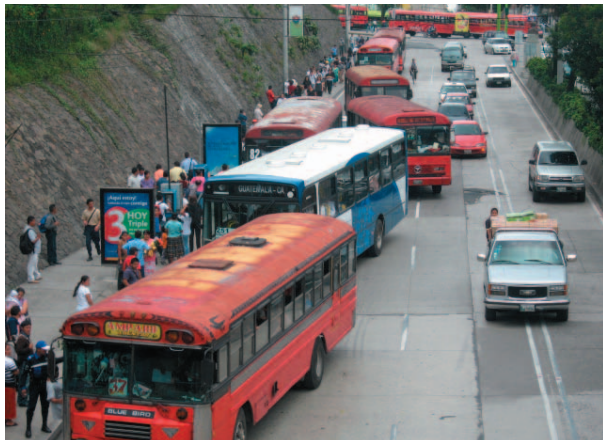
Figura 2.3.1b La circulación en tránsito mixto rápidamente llega a su límite de capacidad cuando coexisten varias rutas o la demanda es alta.
