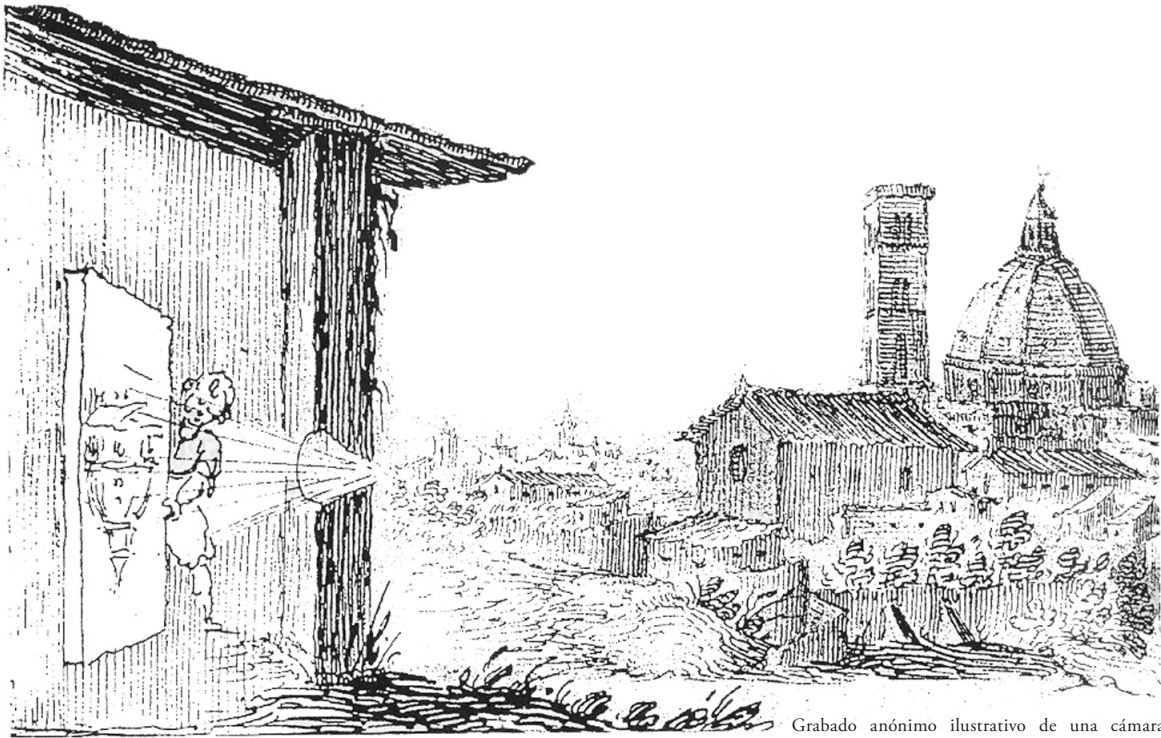
Grabado anónimo ilustrativo de una cámara oscura. S. XVII
