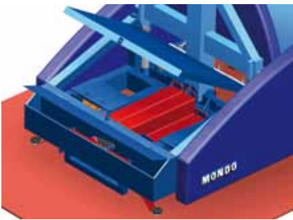
Detalle de la colocación de los contrapesos
