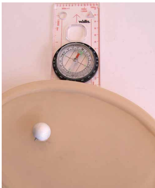
Construye una brújula con un clavo magnetizado y una pelotita de unicel.
