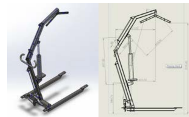
Figura 5: Trabajo simultáneo en SolidWorks ® del diseño de pieza y su corroboración en el plano de estudio (posición de máxima altura).
