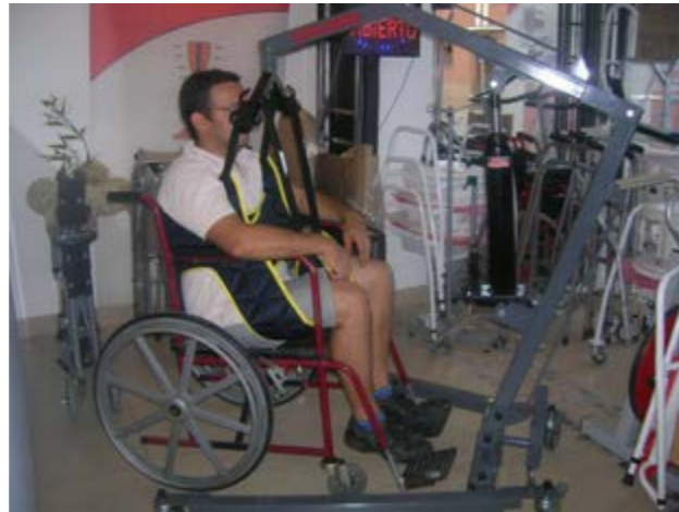
Figura 10: Prototipo de Grúa elevando paciente en silla de rueda.
