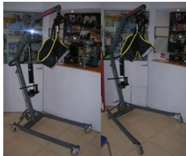
Figura 9: Grúa levanta paciente en posición máxima de apertura del cilindro accionador. Izquierda: con patas rebatidas, Derecha: con patas abiertas para el acceso de sillas de ruedas.
