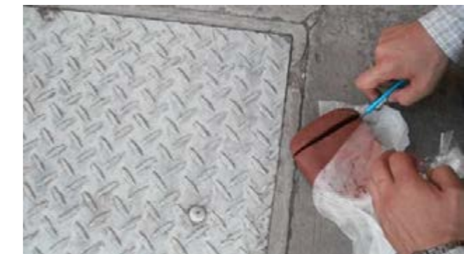
(Figura 7 Impresión del negativo arcilla)
