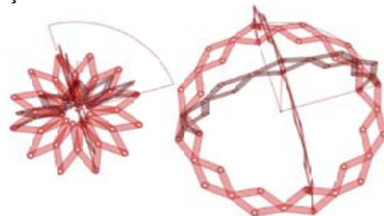
Figura 14. Limites de retração e expansão da estrutura contendo três segmentos por quadrante.
