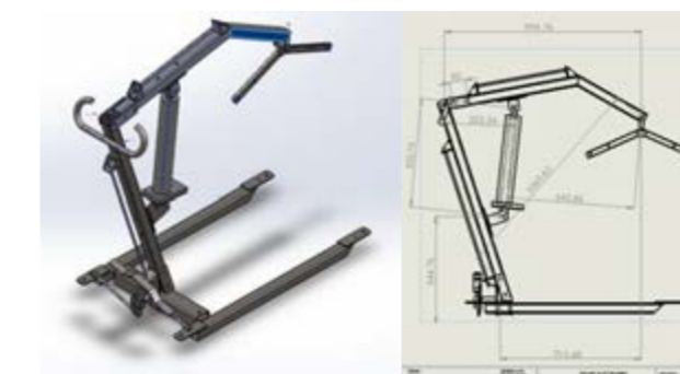
Figura 6: Trabajo simultáneo en SolidWorks ® del diseño de pieza y su corroboración en el plano de estudio (posición de mínima altura).
