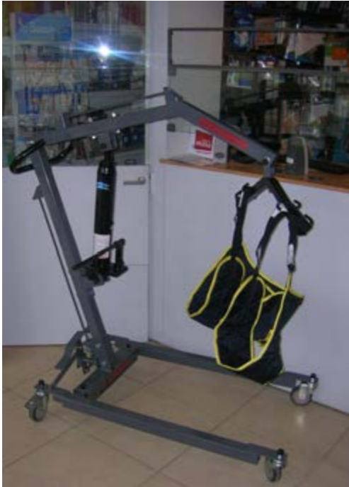
Figura 8: Prototipo de Grúa levanta paciente en posición cerrada del cilindro accionador.
