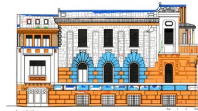
(Figura 1. Un esempio di mappatura del degrado. A sinistra, l'edificio in oggetto viene ricoperto di retinature e simboli che nascondono il manufatto. A destra una tabella uniformata che spiega le tipologie di degrado e i tipi di intervento).
