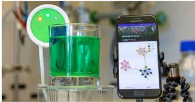
Figura 1: Lengua electrónica (IBM Research en Suiza) [16]
