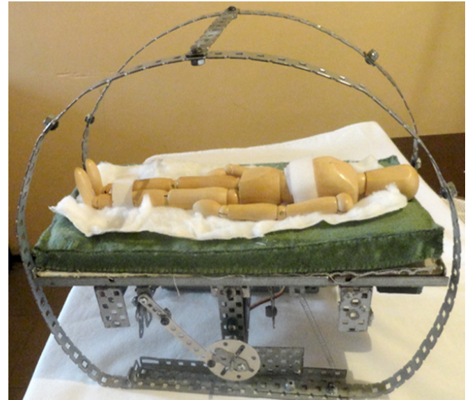
Figura 14. Modelo de Sistema Automatizado para Personas Discapacitadas con Estancias Prolongadas en Cama. Fuente: J. Bernardo Torres (2015).
