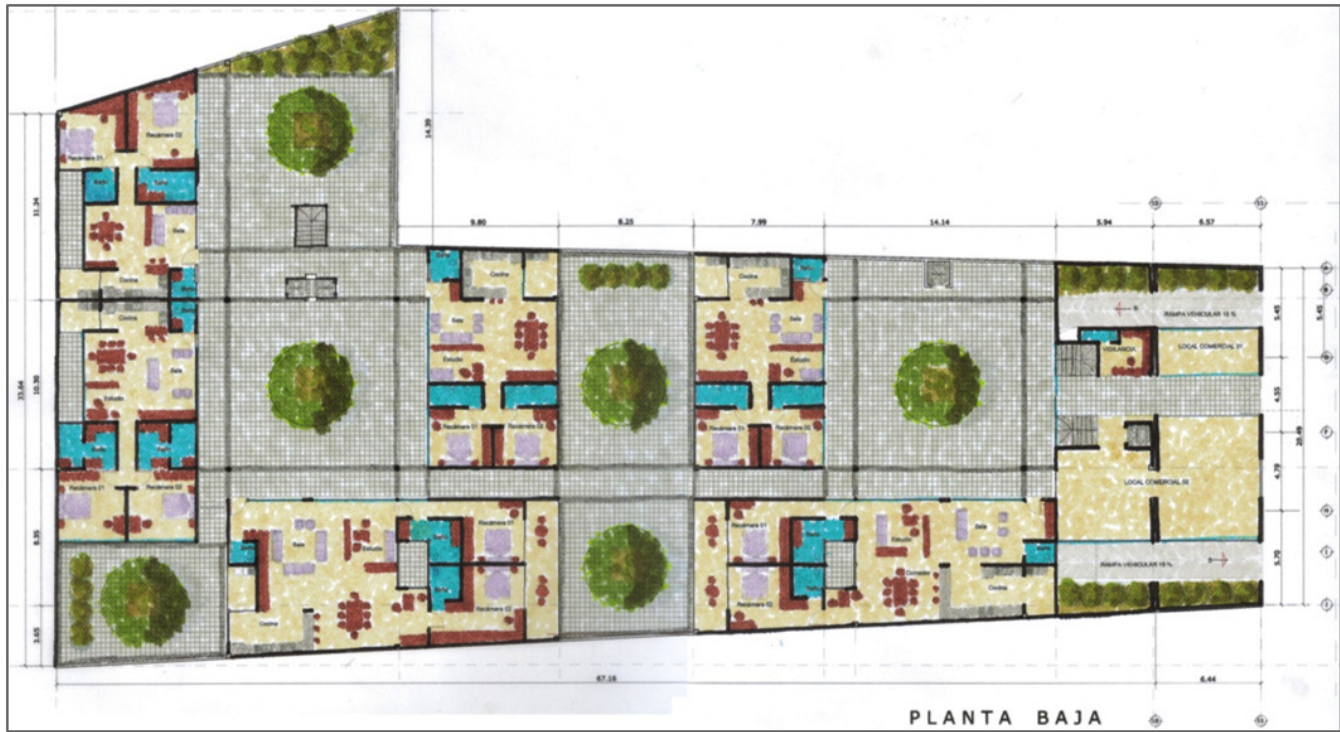
Fig. 17. Anteproyecto de uso habitacional y comercial de bajo impacto para la recuperación del inmueble ubicado en av. Bucareli 136. Donde se conserva la primer crujía existente y se construyen nuevas arquitecturas con alturas moderadas hacia el interior del predio. (Fdo. Ortiz)
