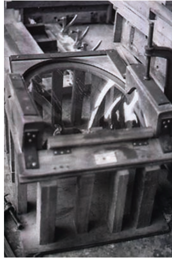
Moldeo de una asientomediante el proceso de termoformado macho-hembra.
