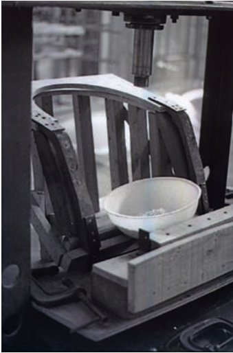
Moldeo de una asientomediante el proceso de termoformado macho-hembra.
