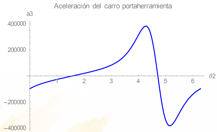
Figura 3.7. Aceleración del carro portaherramienta
