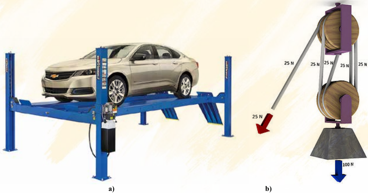
Figura 1.4. a) Elevador electrohidráulico a base de cables y poleas b) Polipasto
