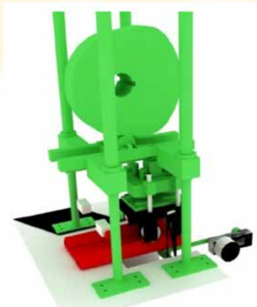
Figura 6.6. Máquina para imprimir relieves en jabones, controlada por una leva
