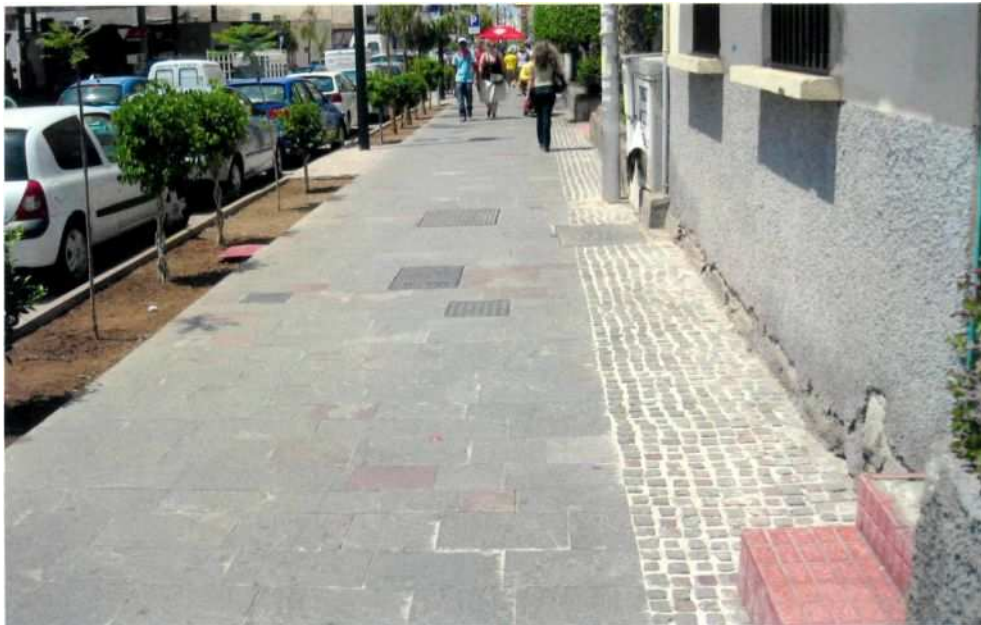
Itinerario peatonal organizado en bandas (Arona, Santa Cruz de Tenerife). Se pueden apreciar claramente las bandas de afección a fachada, la banda libre y la banda de mobilidario.
