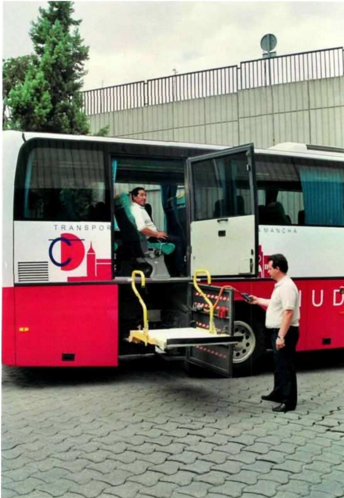
Autocar interurbano dotado de plataforma elevadora.
