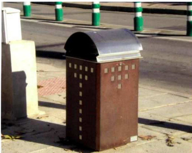
Diseño correcto de papeletera, proyectada hasta el suelo y con boca lateral (Ciudad Real).
