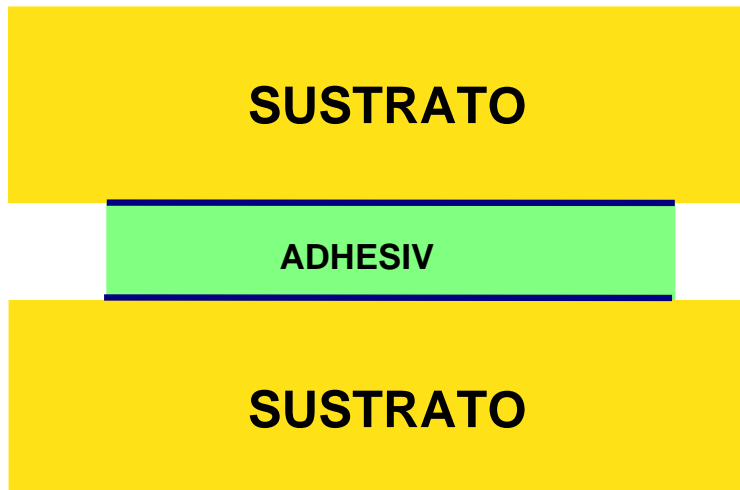
Fig.2: Esquema básico de una unión adhesiva.
