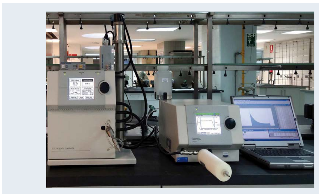
Figura 8.2. Separador de barrido de las partículas por movilidad (SMPS)
