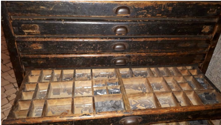
Gavetas tipográficas. Cada uma contém um alfabeto com determinados tipos de fontes e tamanhos. Fonte (fotografia): Livraria Férin, Lisboa.
