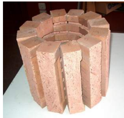
Disposición de ladrillos para pared de un horno pequeño de forma cilíndrica
