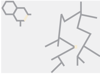
FIGURA 4-31 Grietas localizadas formadas durante la corrosión bajo tensión
