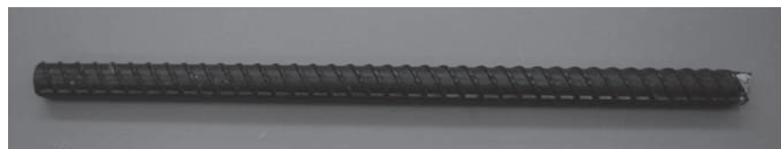
FIGURA 7-7 Fotografía de una muestra de barra de refuerzo
