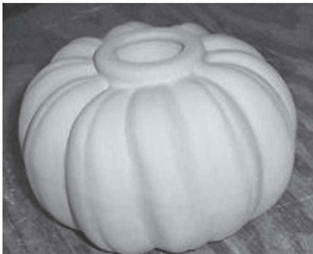
FIGURA 6-20 Calabaza de bisque previa al vidriado
