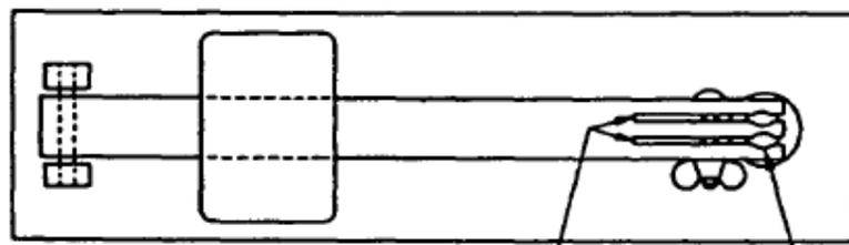
Muesca hecha en el brazo para facilitar la fijación del cable del portalámparas
