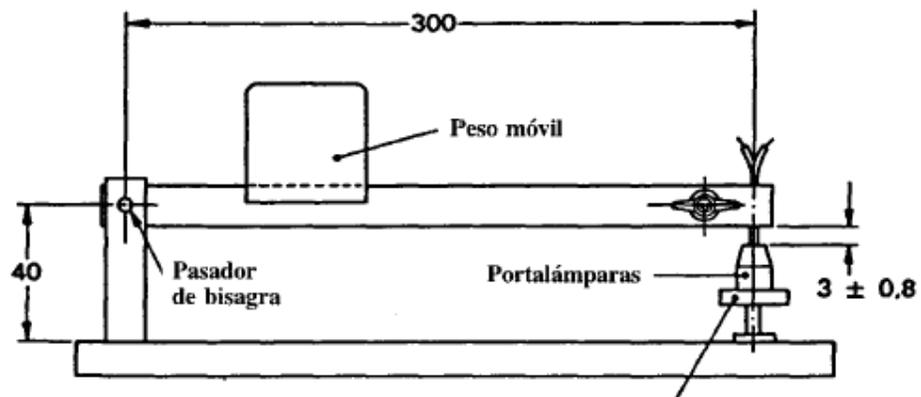
Apoyo que permite alzar el portalámparas con el fin de que el brazo de palanca esté en posición horizontal en el momento de la primera aplicación de la fuerza
