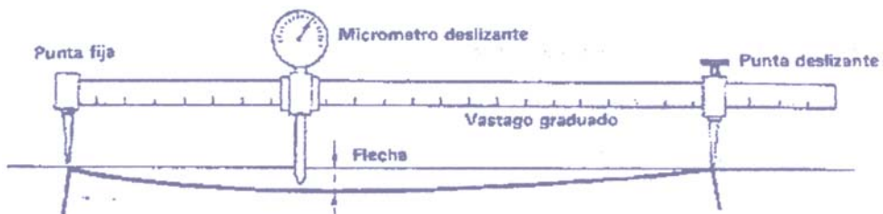
Figura 2 — Esquema del Desviómetro
