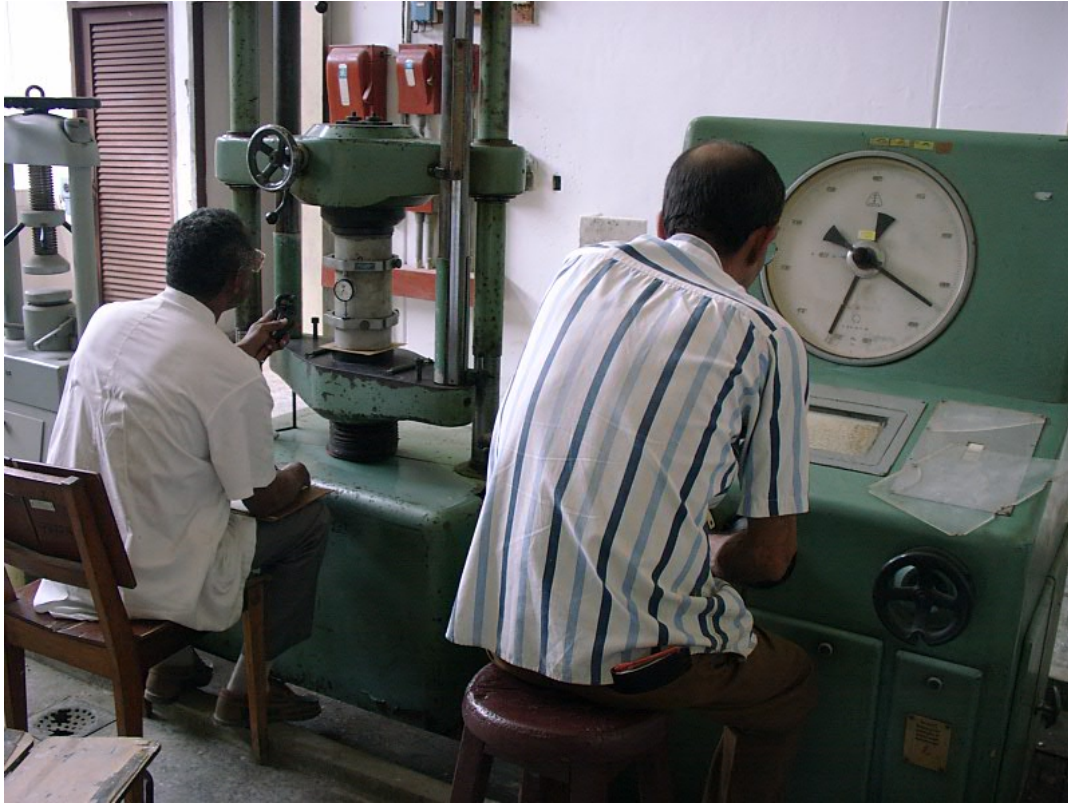
Foto — Colocación de defórmeters de carátula en probetas cilíndricas normalizadas y ensayo del módulo de elasticidad estático ( E_s ) del hormigón en compresión
