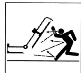
**A.9.5** Objetos lanzados o en vuelo – Segadora rotativa de acoplamiento lateral
