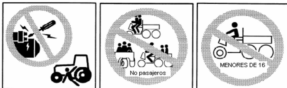
**Figura D.30 — Ejemplos de imágenes pictóricas usando un círculo rojo con una barra diagonal para comunicar la idea de una acción prohibida**
