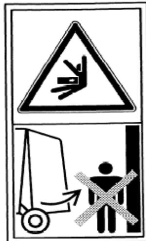
**C.2.9** Manténgase alejado de la puerta levantada a menos que esté colocado el mecanismo de bloqueo de seguridad
