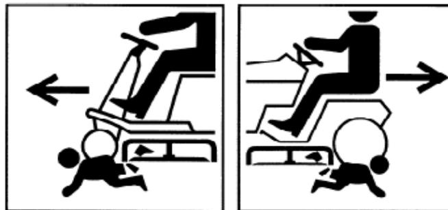
Figura D.23 — Ejemplos de imágenes pictóricas usando flechas para representar la dirección de movimiento de máquinas completas
