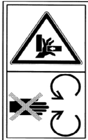
**C.2.32** La palanca opera por medio de un resorte de presión. Manténgase alejado mientras está funcionando
