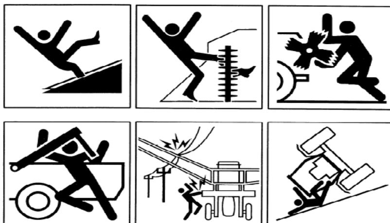
Figura D.16 — Ejemplos de imágenes pictóricas mostrando máquinas y componentes grandes que producen riesgos
