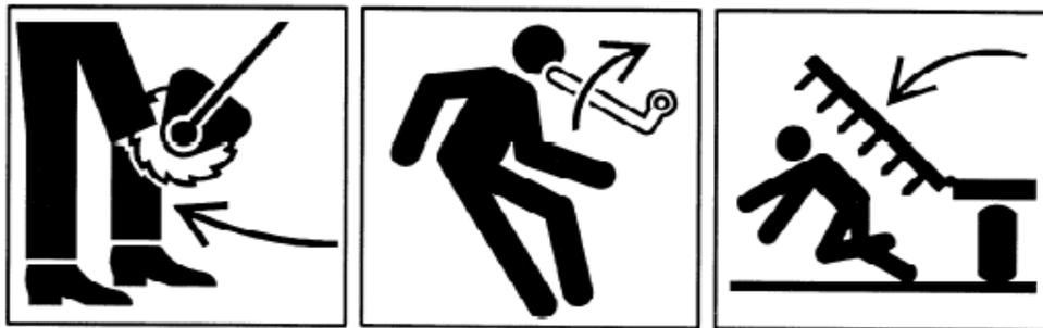
**Figura D.21 — Ejemplos de imágenes pictóricas usando flechas para representar la dirección de movimiento de componentes de máquinas**
