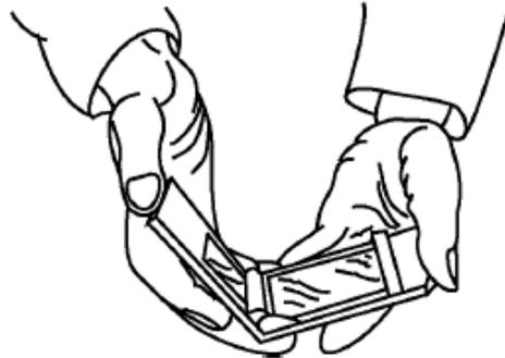
**Fig.2 — Aparato para ensayo de plegado tipo 1 en uso**
