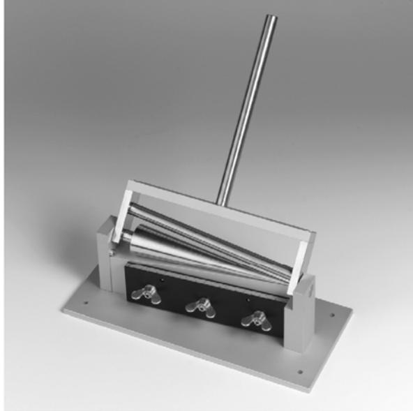
Fig.1 – Aparato de ensayo de mandril cónico
