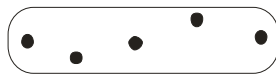
Figura 4 — Puntos de medición de la altura de corte de los filamentos en la escoba
