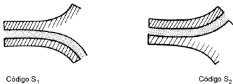
Figura 9 — Exfoliación del material
