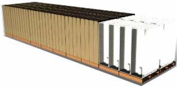
Fig. 8 Container de 2.3 x 2.2 x 12mt. con Capacidad para 150 ataúdes desarmados.
