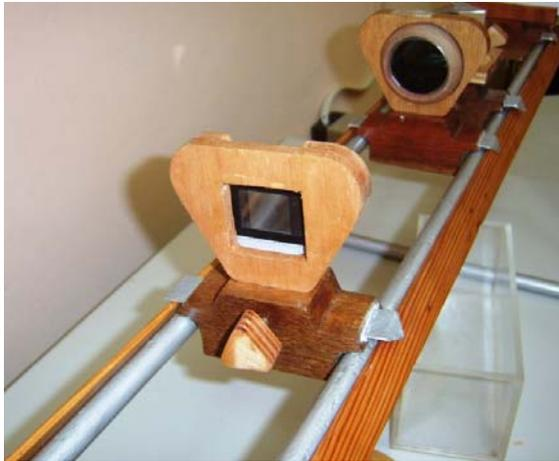
**Figura 4.** En primer plano se aprecia un soporte con una diapositiva y al fondo un polarizador.
