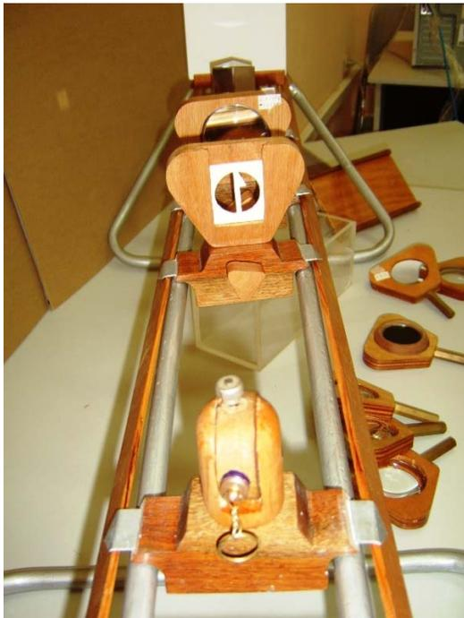
**Figura 3.** Plano que muestra la estructura del banco, el puntero láser en su base y los soportes de una flecha objeto, una lente y la pantalla.
