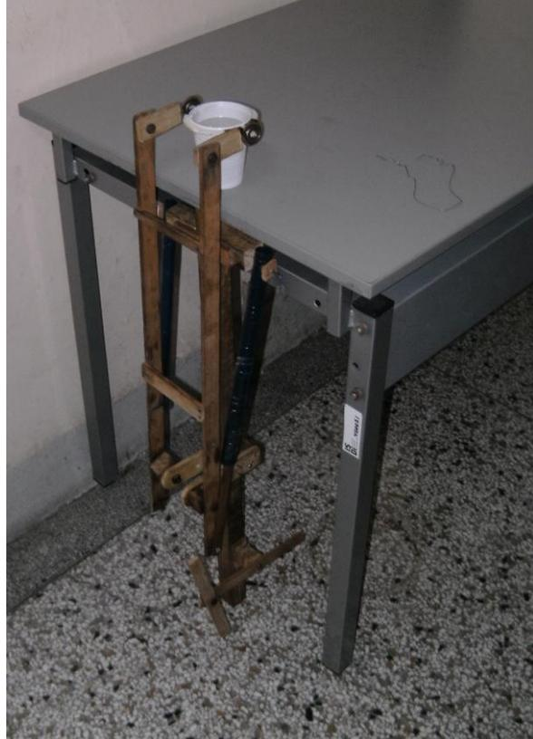
**Solución No. 4.** En esta propuesta se utiliza una rueda ovalada en un extremo, de modo que al girar sobre ese extremo, levanta el vaso y con el impulso lo coloca fuera de la mesa donde está unido por un hilo con otro vaso, con un poco menos de agua, cayendo lentamente.
