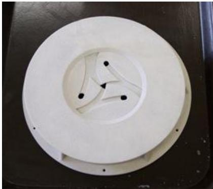
Una vez con el modelo muy próximo a lo que se quería, entonces se imprimió, ¿cómo?, pues recurriendo a otra NT más: el prototipado rápido (Rapid Prototyping). Mediante un impresora 3D, se obtuvo una reproducción física a escala del ID con gran detalle, el cual serviría para realizar pruebas de comportamiento que tendría cuando el agua con partículas pasara por él. Esta simulación ayudaría a confirmar las hipótesis acerca de la forma y de cómo puede afectar su funcionamiento.
