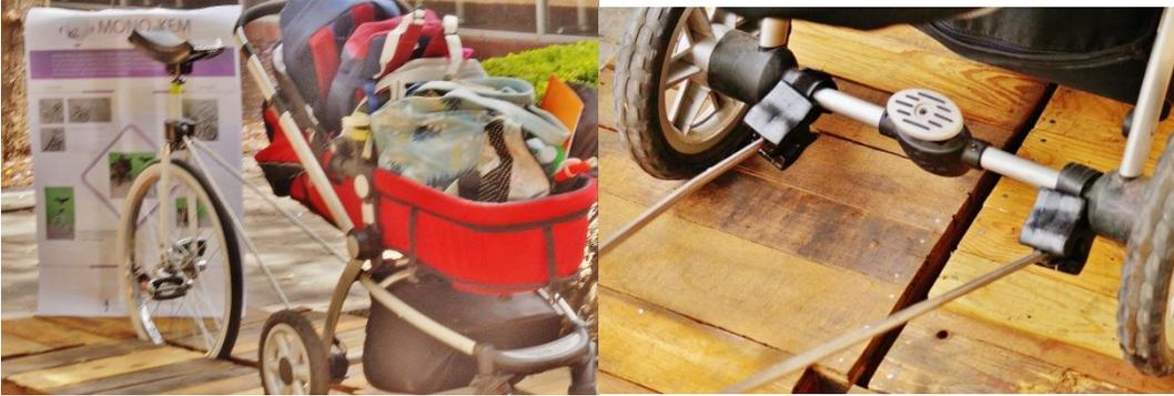
El resultado es un monociclo, que por las dimensiones se tuvo que diseñar para esta función, en la columna del asiento se coloca una pieza con una rotula que se conecta a dos tubos de aluminio y cada uno de ellos se coloca al vehículo que se pretende impulsar.
