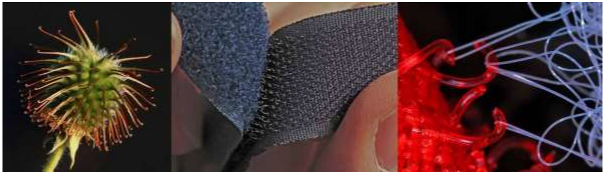
Izquierda: Arctium lappa , semilla del cardo que inspiró el velcro. Centro: detalle de las cintas. Derecha: detalle del agarre del velcro.
