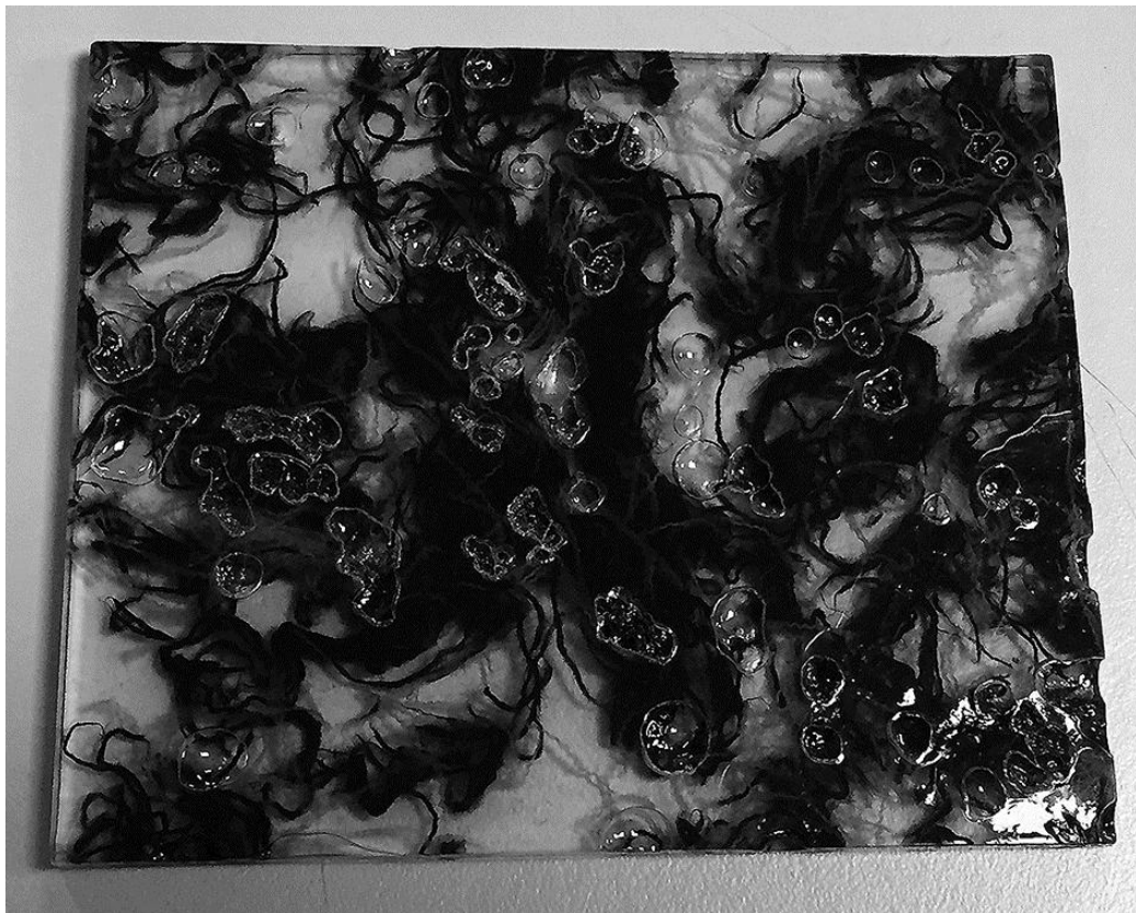
Figura 1. Muestra de lámina defectuosa de mezclilla-PMMA (foto del autor).
