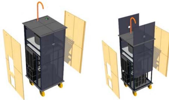
Figura 4: Ilustración en explosión de las placas laterales. Fuente: FreshWater
