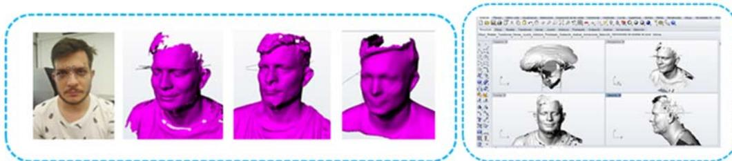
**-Fig.2. Se puede observar el proceso de toma de datos de manera virtual con una usuaria con los escáneres, en orden desde la izq. Go! Scan, Sense y Kinect, y con el otro usuario como se realizó la toma de datos con el calibrador.**
