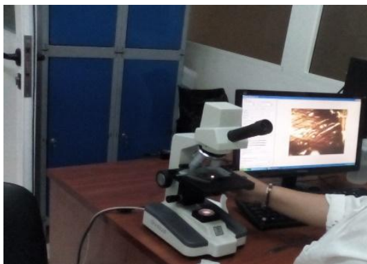
Fig.10. Microscopio óptico. Precisión de 40x a 100x Laboratorio de Diagnóstico Empresa Restaura. Arquitectura y Urbanismo.
