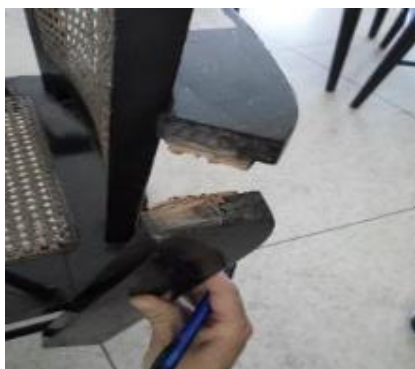
Fig. 35. Rotura del ensamble.
