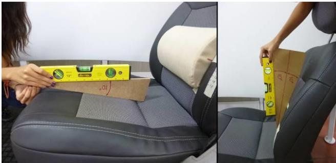
**Figura 2.** Ángulos de la bandeja del asiento ( $10^\circ$ ) y del espaldar ( $110^\circ$ ).
